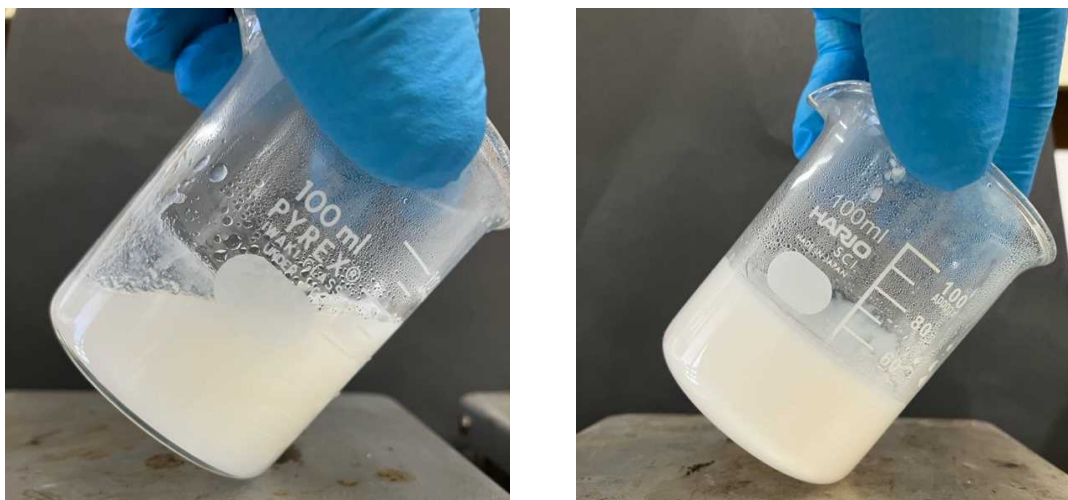
図. 23 析出後の溶液状態 溶解濃度 2%(左)10%(右)
