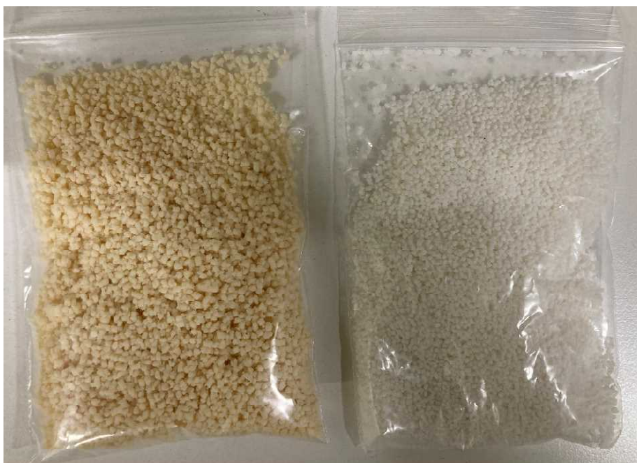
図．29 黄変した回収 NY 樹脂(左)と白色の回収 NY 樹脂(右)
