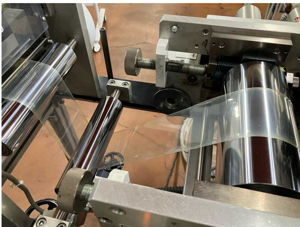
図. 55 プラストミル装置による成膜（リサイクル NY）
