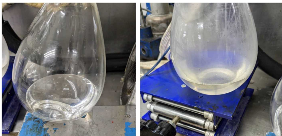
図. 40 2pass テスト中の抽出液(左)と残留液(右)
