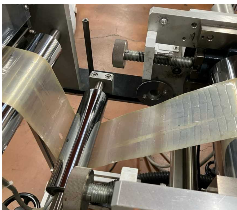
図. 102 プラストミル装置による成膜（リサイクル NY）
