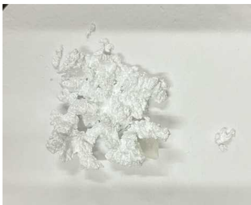
図．112 回収した P0 混合樹脂
