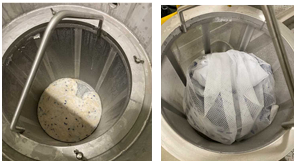
図. 92 左：回収時にカゴ底面に張り付いている様子
