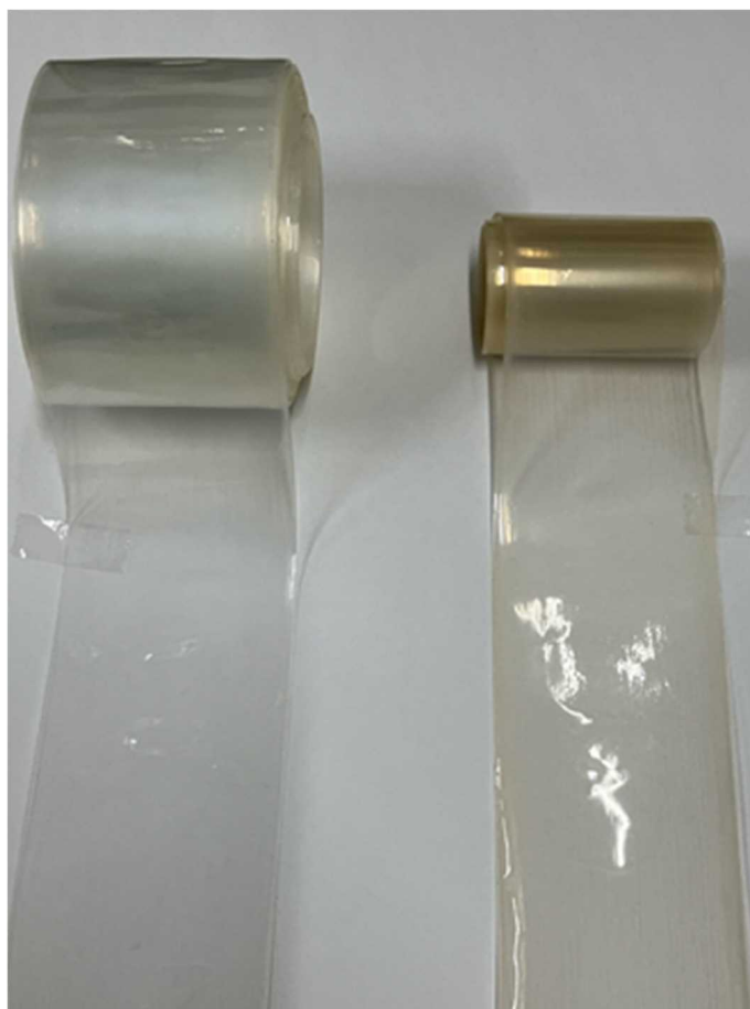
図．56 (左)バージン NY 樹脂使用 (右)リサイクル NY 樹脂使用 *残留溶剤 1%以下
