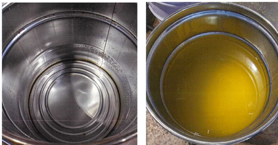
図. 42 2pass テスト中の留出液(左)と残留液(右)
