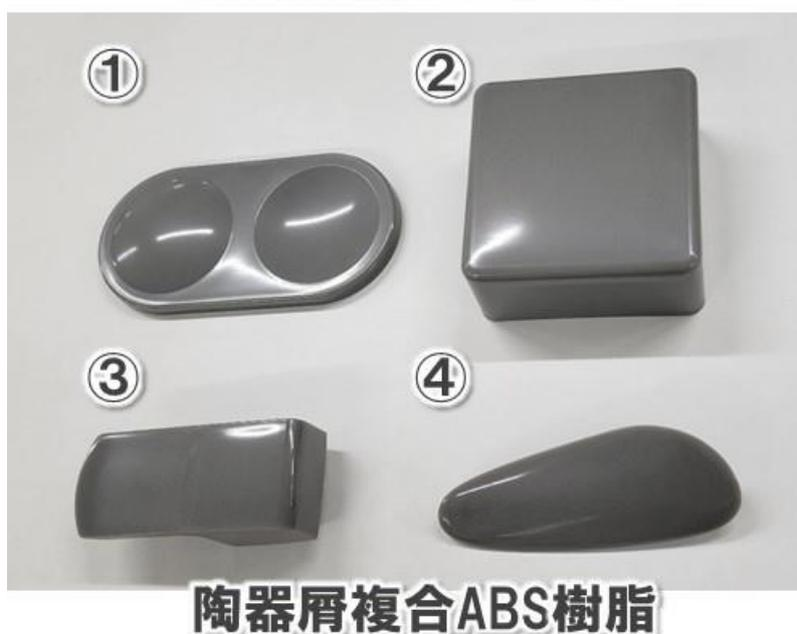
図 3-46. 各開発材による成形試作品
