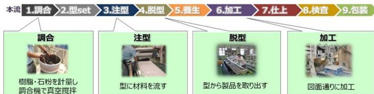
図 3-48. 注型による ML カウンターの製造工程
