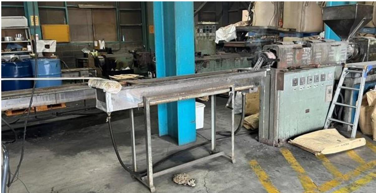
図 3-30. ラボ試作用押出機
