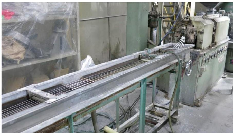
図 4-8. 試作に使用した押出機
