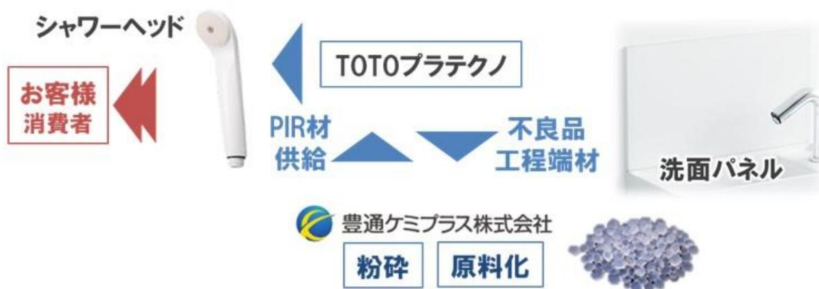
図 3-37. 洗面パネル部品の工程内端材の再利用検討
