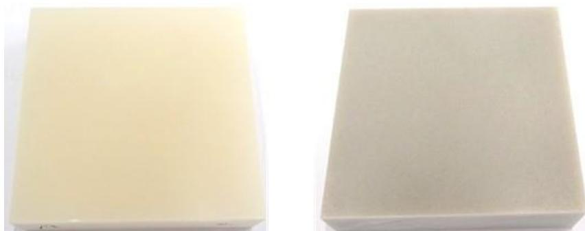
図 3-62. 再生樹脂カウンターの外観 (左)陶器屑非含有、(右)陶器屑配合
