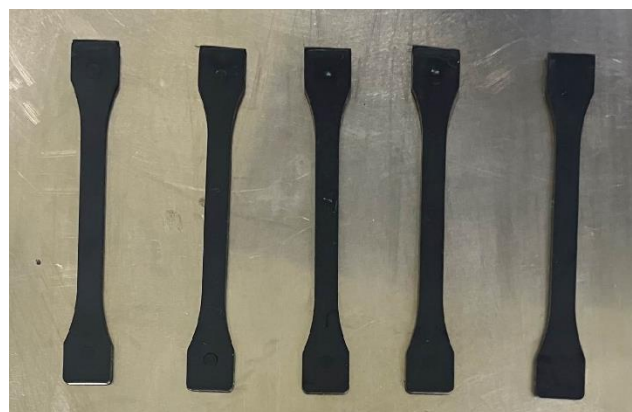
図 11 小型ダンベル試験片（ISO527-2 1BA）
