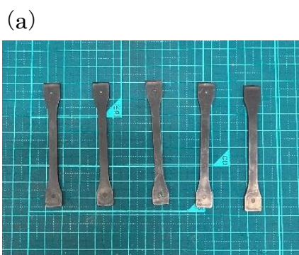
図 15 (a) 難燃バージン LDPE の引張試験前、(b) 引張試験後
