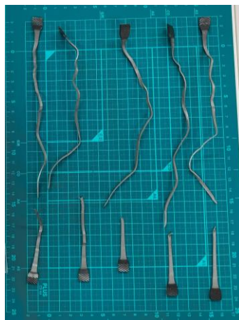
図 49 (a) 0.1% TJ20A 難燃バージン LDPE の引張試験前、(b) 引張試験後
