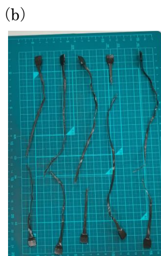
図 19 (a) 0.1% 24PS 非難燃バージン LDPE の引張試験前、(b) 引張試験後
