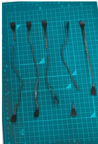
図 48 (a) 5% 24YD 難燃バージン LDPE の引張試験前、(b) 引張試験後
