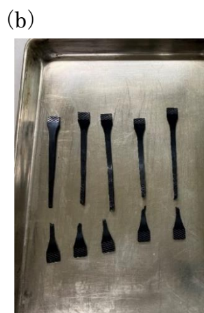
図 14 (a) 非難燃再生 LDPE の引張試験前、(b) 引張試験後
