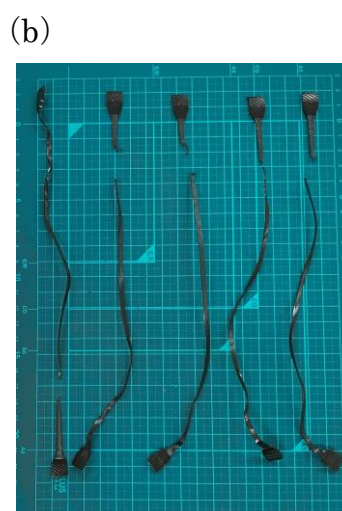
図 21 (a) 1% 24PS 非難燃バージン LDPE の引張試験前、(b) 引張試験後
