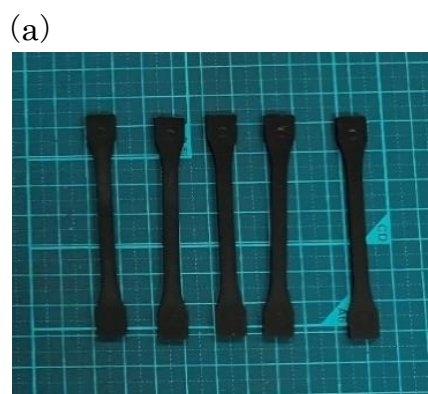
図 14 (a) 非難燃再生 LDPE の引張試験前、(b) 引張試験後
