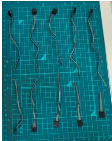
図 51 (a) 1% TJ20A 難燃バージン LDPE の引張試験前、(b) 引張試験後
