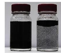
図2. 水中攪拌30秒後分散状態 左:CSCNT 右:一般のCNT
