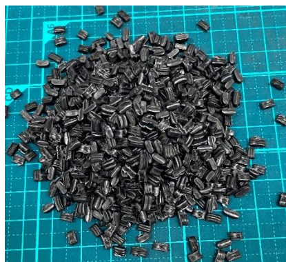
図 72 難燃性バージン LDPE の SWOM 後の粉碎品に 24PS を 2%添加したペレット
