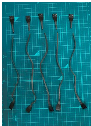
図 53 (a) 5% TJ20A 難燃バージン LDPE の引張試験前、(b) 引張試験後
