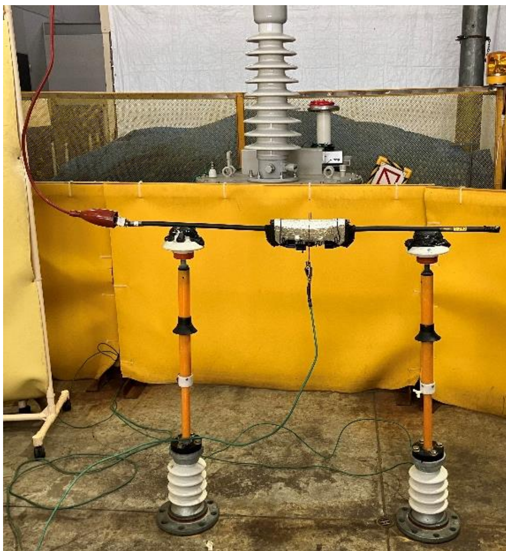
図 78 耐電圧試験設備にセット時の写真
