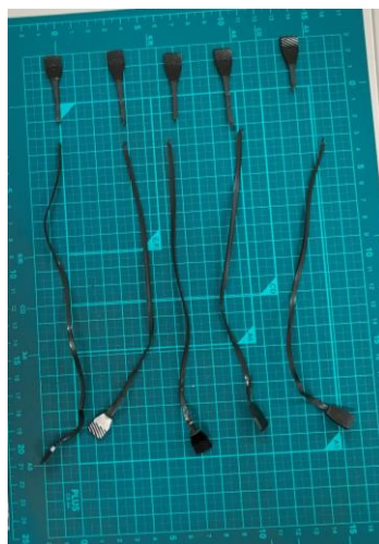
図 32 (a) 3% TJ20A 非難燃バージン LDPE の引張試験前、(b) 引張試験後
