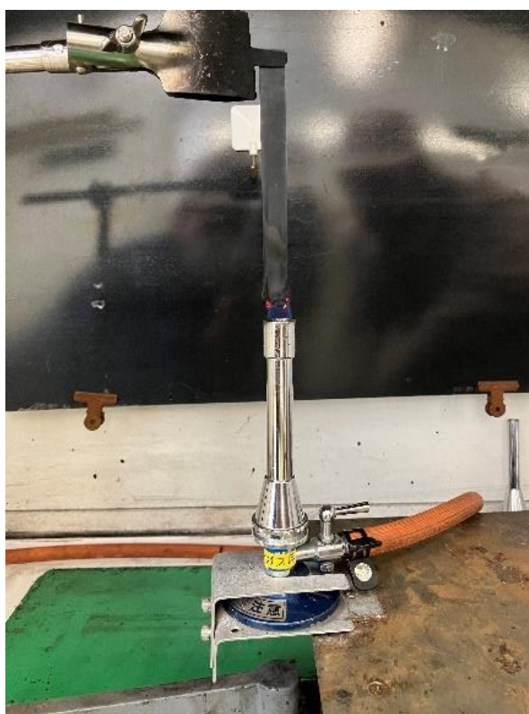
図 82 (a) 難燃性試験 接炎前、(b) 難燃性試験 接炎時
