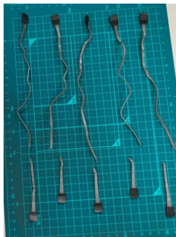
図 50 (a) 0.5% TJ20A 難燃バージン LDPE の引張試験前、(b) 引張試験後
