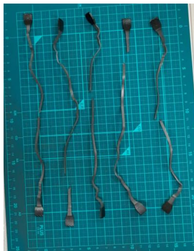
図 52 (a) 3% TJ20A 難燃バージン LDPE の引張試験前、(b) 引張試験後
