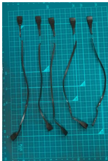
図 33 (a) 5% TJ20A 非難燃バージン LDPE の引張試験前、(b) 引張試験後
