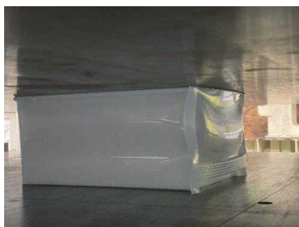
図 4.3-4 圧縮試験の状況
