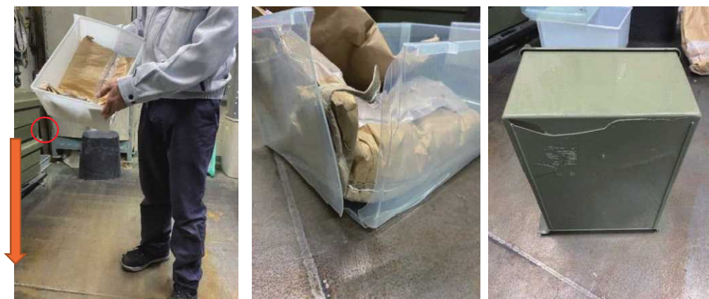
図 4. 3-2 コーナー落下試験の状況
