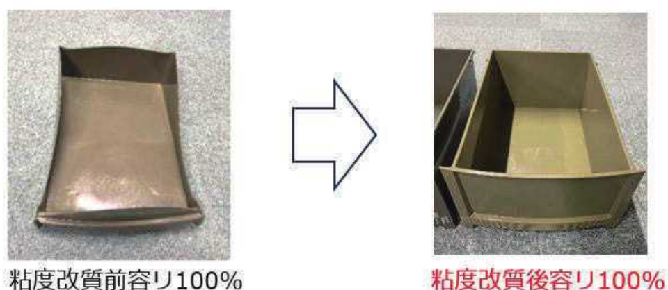
図 4.3-1 熔融粘度改質前後における成形品の状態
