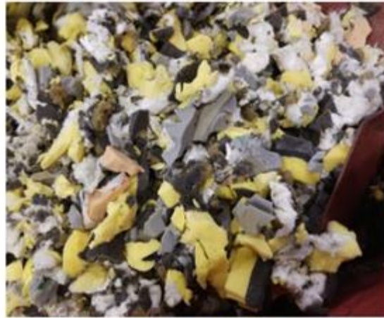
図 39 ウレタンフォームの減容・固化テスト テスト⑦の詳細及び参考写真
