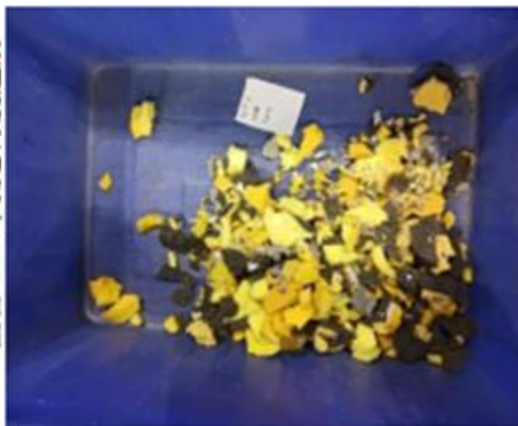
光学選別機2回目Eject側 1回目のDrop側を再度選別
