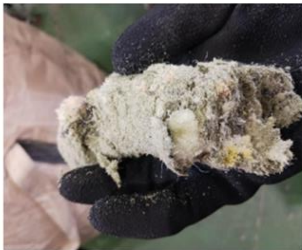
排出された固形化物(投入開始後数分で排出されたもの)
