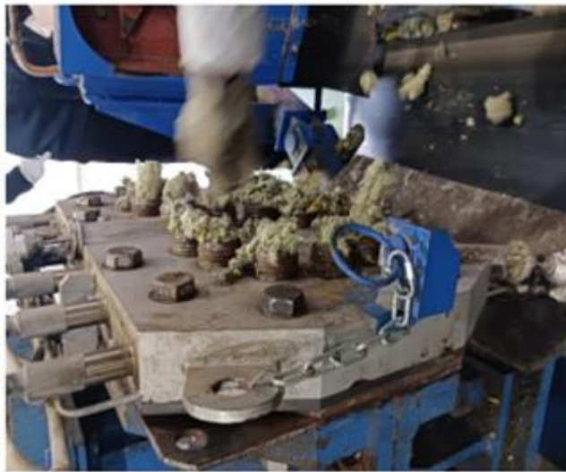
ノズルの様子 2~3個のノズルからのみ排出
