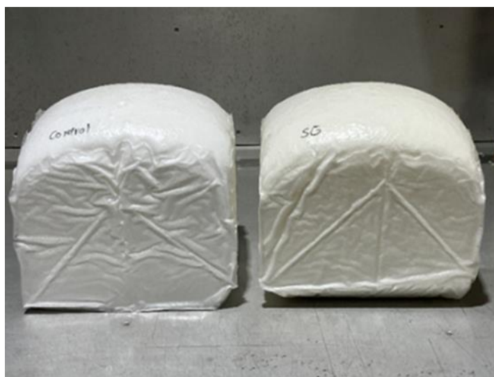
図 63 参考写真：フォーム写真（左：標準品、右：再生品）
