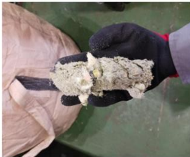
排出された固形化物(投入開始後数分で排出されたもの)
