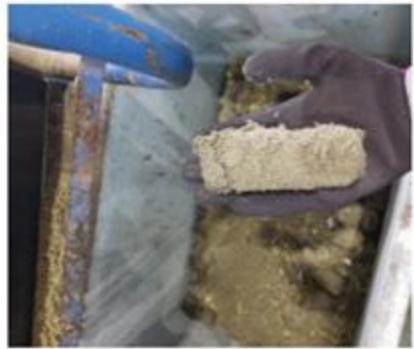
図形化したものも排出されたものの、大半が粉状だった。 テスト①の減比重0.16 テスト②の減比重0.35
