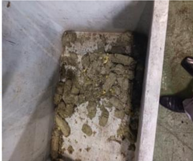
投入再開から30秒後、排出開始 排出された固形化物
