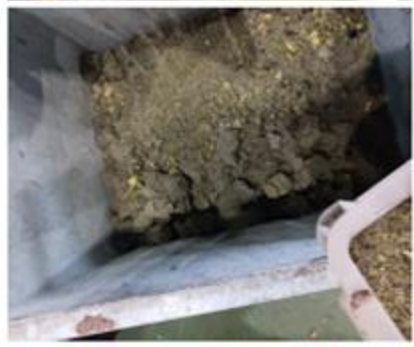
図形化したものも排出されたものの、大半が粉状だった。 テスト①の減比重0.16 テスト②の減比重0.35
