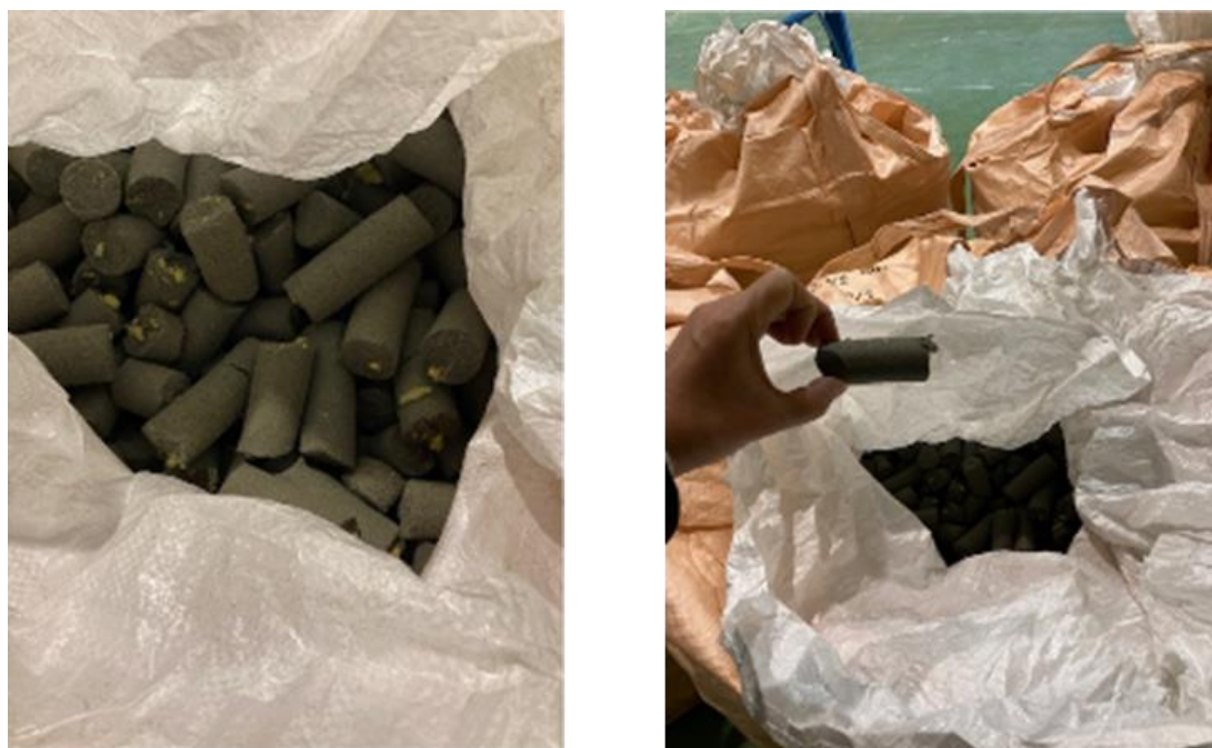
図 56 減容化したペレット状の分解用樹脂
