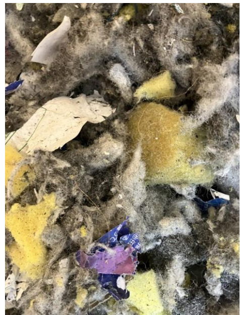
図 50 粉碎後の混入物（左：紙屑、エナメル線が多く混入）
