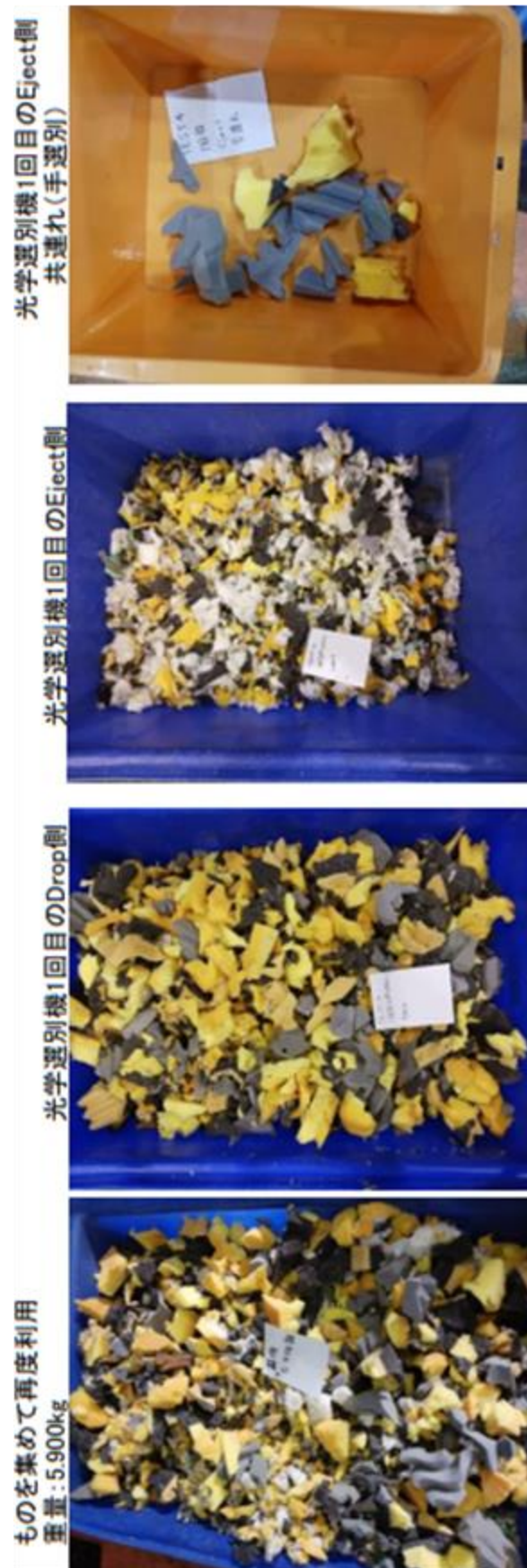
図 28 ウレタンフォームの光学選別による選別テスト テスト④参考写真
