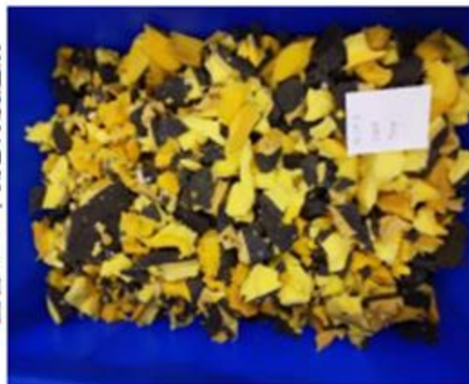
光学選別機2回目Drop側 1回目のDrop側を再度選別
