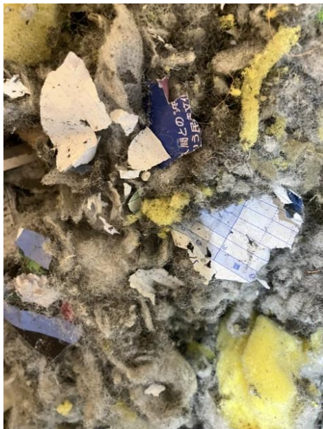
図 50 粉碎後の混入物（左：紙屑、エナメル線が多く混入）
