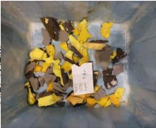
光学選別機2回目Eject側 共連れ(手選別)
