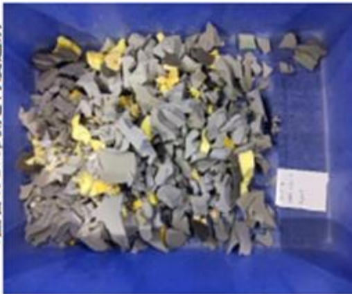
光学選別機2回目Eject側 1回目Drop側を再度選別
