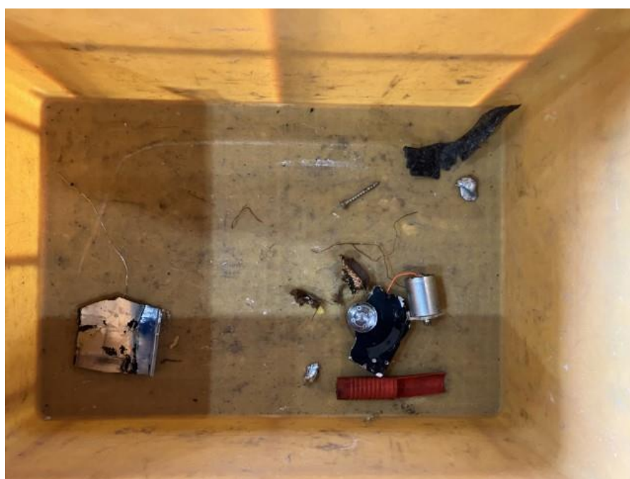
図 52 混入物（プラスチック片、小型モーター、金属製のネジ、ゴム片）
