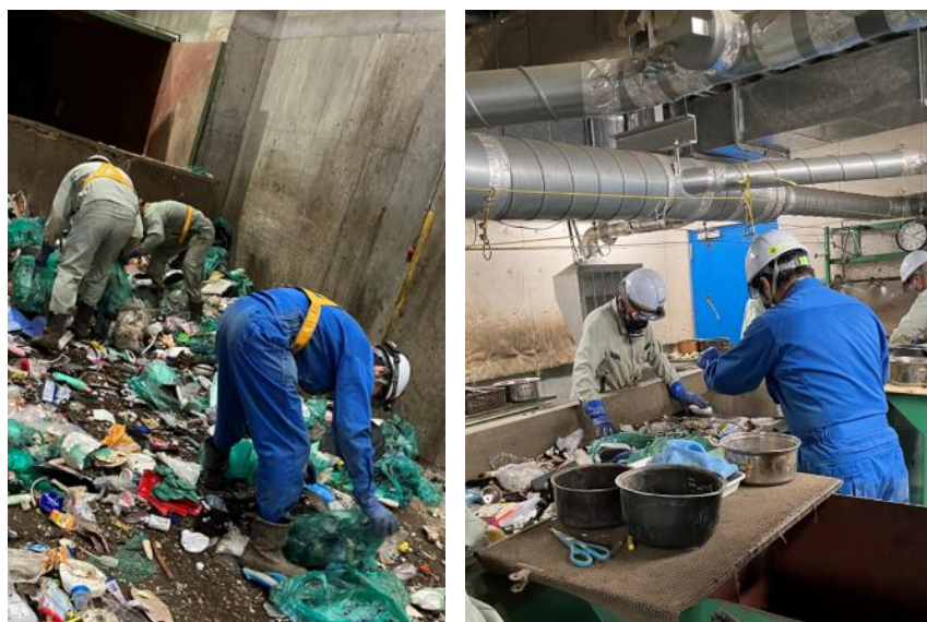
図 8-7 手選別作業の様子(左:破袋機投入前、右:破袋後)
