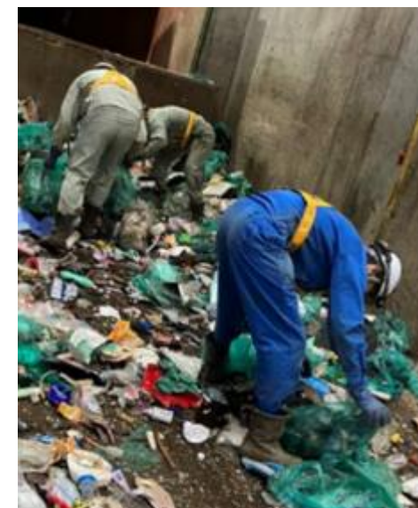
破袋機投入前にごみを展開し、職員によるピックアップ回収を実施
