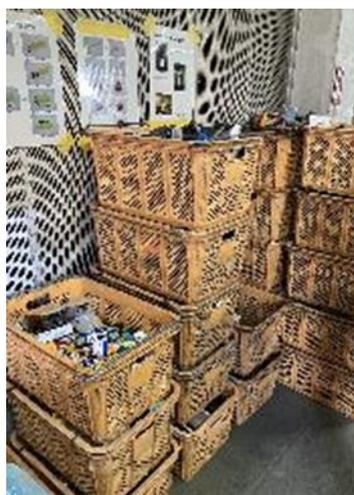
電池の種類ごとにボックスに入れて(電池単体)保管
