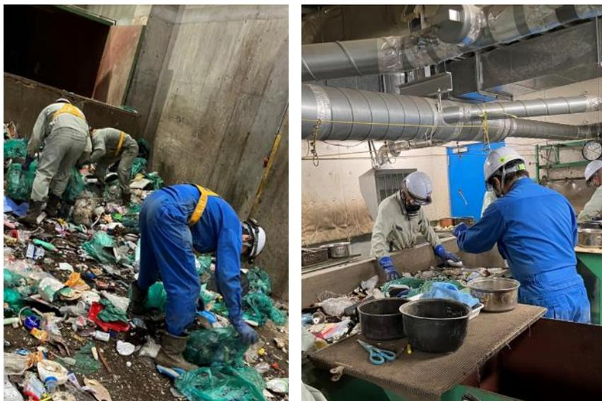
図 4-9 手選別作業の様子(左:破袋機投入前、右:破袋後)
