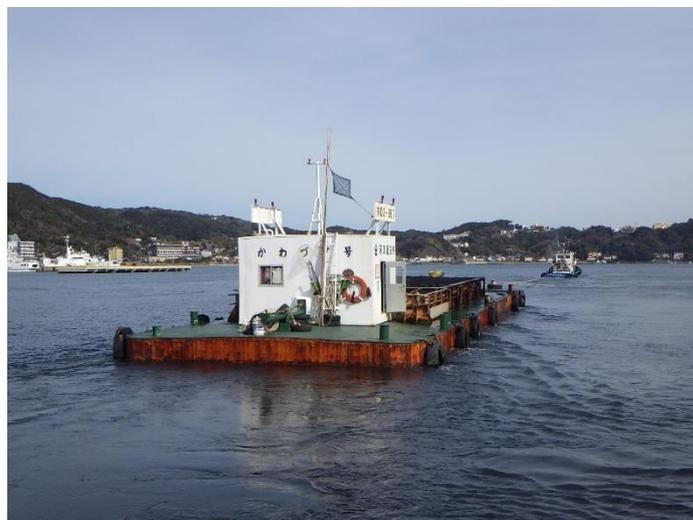
写真-1 曳船による底開式土運船の曳航状況
