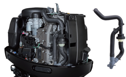
マイクロプラスチック回収装置を取り付けた船外機
