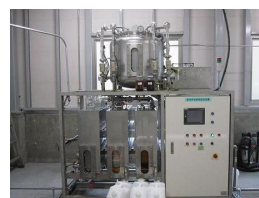
バイオディーゼル燃料製造設備 の本体となる攪拌沈澱装置
