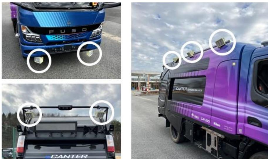
図 IV-2-3-1 近赤外線照明の搭載状況
