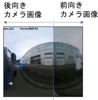
図 IV-2-1-2 側方における前向きと後向きのカメラ画像結合
