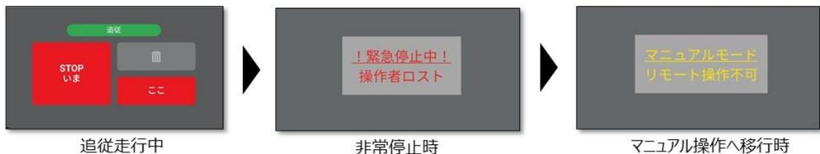
図 IV-2-1-3 非常停止時のリモート端末の表示例（運転者ロスト時）
