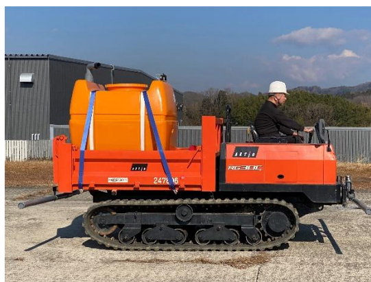
図 5 不整地運搬車を使った低コスト型の散布システム
