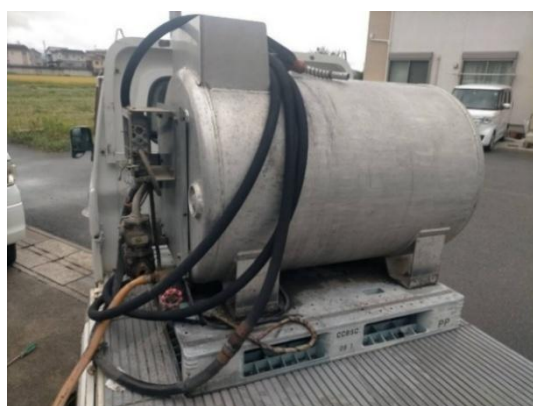
改造前のローリータンク (ガソリンスタンドが灯油を販売するために 軽トラックに積むタンクの中古品)
