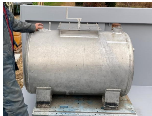
改造後の発酵槽
