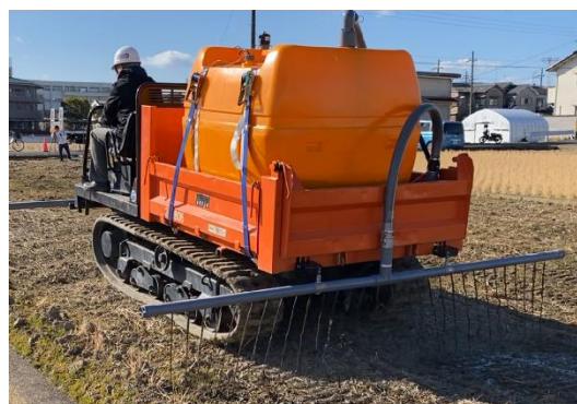
車体後部で前進しながら散布する様子
