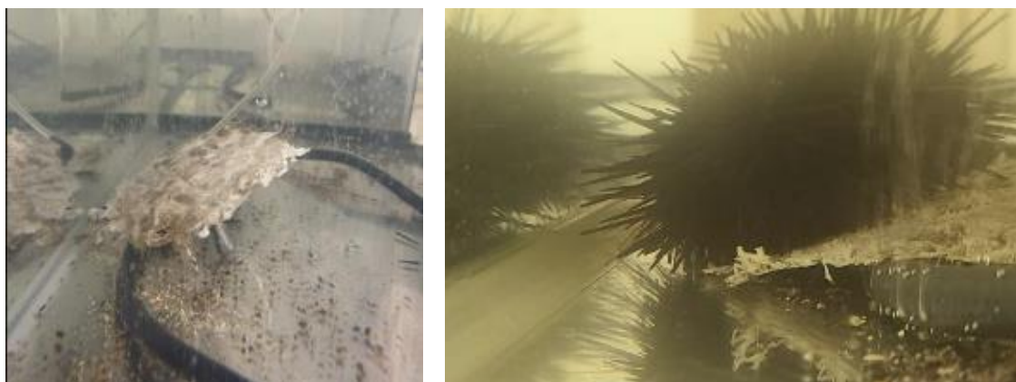
図 6-2 水槽内に投入した板状 Mater-Bi(左)と板状 Mater-Bi を食べるウニの様子(右)
