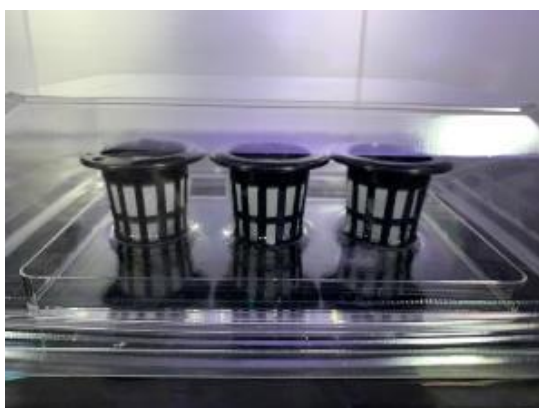
図 3-20 保水性評価試験。あらかじめ水で飽和した培地を薄く水を張ったトレイにおき、保持する水分量の低下を計測する。
