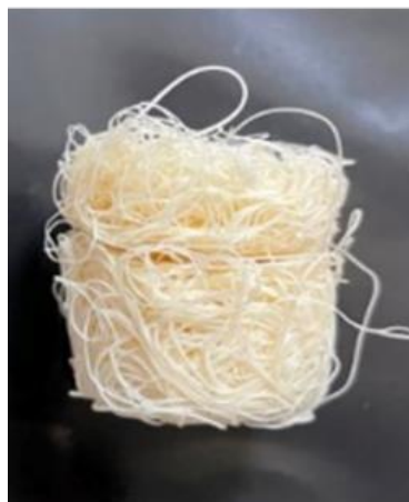
図 3-1 Mater-Bi を繊維化し、温湯に入れて成形した培地
