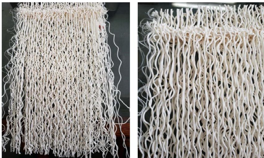
図 4-2 パネフリ工業 1 回目試作② 210℃で成形したもの。温度をやや下げると硬くなりすぎて絡まなかった。
