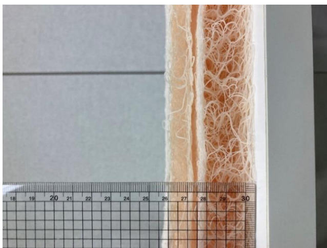
図 4-15 パネフリ工業 厚み比較。左が 2 回目の試作品で、右が 3 回目の試作品。
