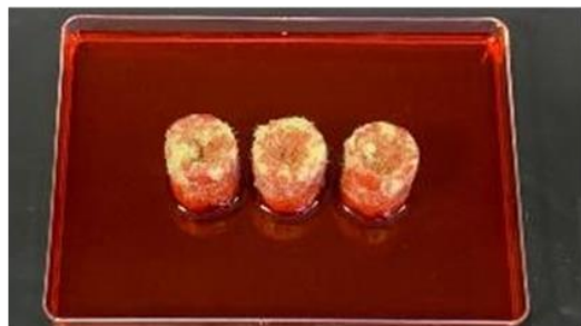
図 3-21 乾燥した Mater-Bi、酢酸セルロース、PLA レーヨンおよびウレタン、ロックウール培地を着色した水に浸けて吸水させ、培地の吸水性を評価した。図は 19 時間後の吸水状況を示す。(左；前からみた図、右；上からみた図)
