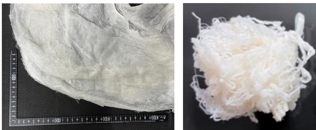
図 3-9 Mater-Bi (開発品グレード)を綿飴機で繊維化し（左）熱水でブロック化した（右）
