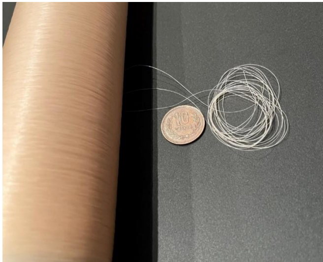
図 4-20 C 社 試作品① 400 デニールのモノフィラメント試作品
