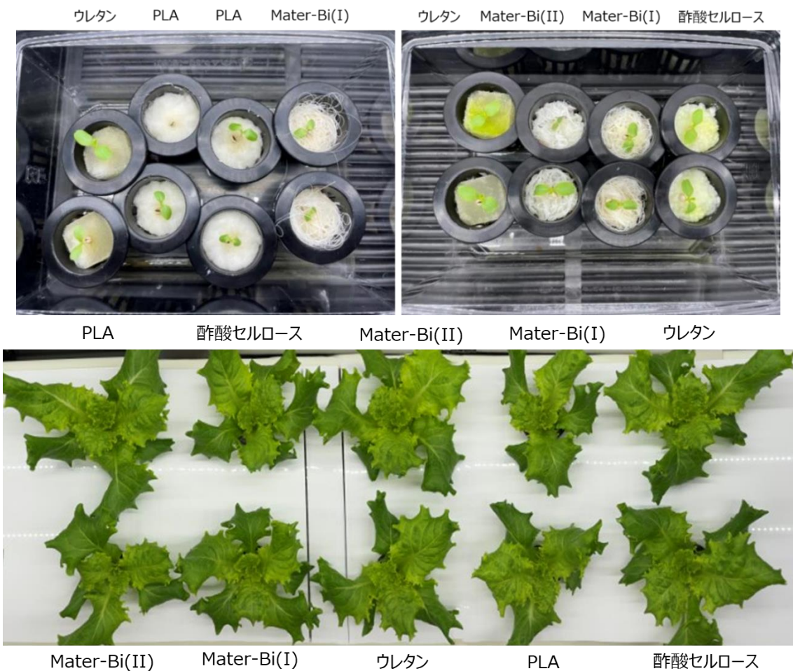
図 3-17 糸巻き器により繊維化した Mater-Bi [Mater-Bi (I)]、綿あめ機で射出生成した Mater-Bi [Mater-Bi (II)]、綿状のポリ乳酸素材 (PLA)、包帯状の酢酸セルロース素材 (酢酸セルロース) およびウレタン培地 (ウレタン) に播種した 1 週間後 (上) お
