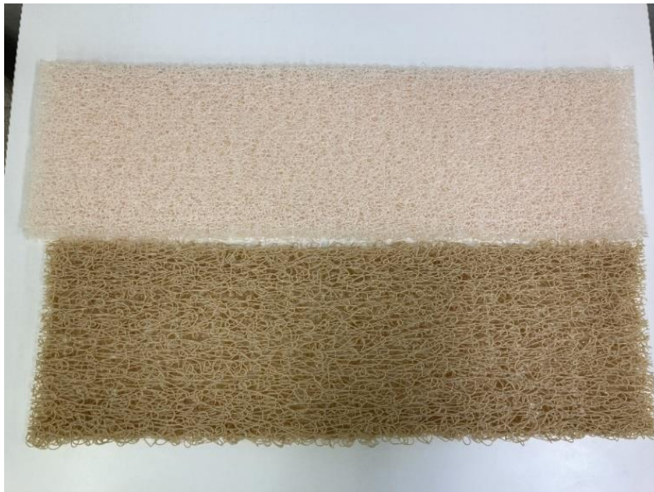
図 3-10 押出成形による MaterBi 加工品(上; ES01G, 下; EF04P)
