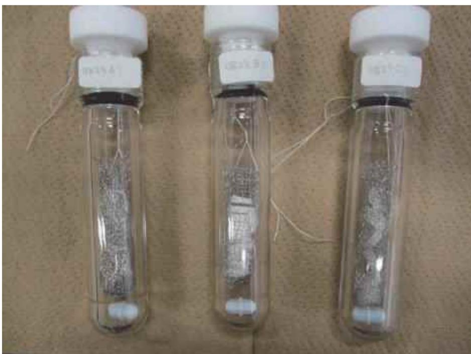
また、ペレット化触媒は、使用中に割れてしまうケースが散見された（写真 10）。粉末が流路に入るなどタブレット形状だと使用しづらく、寿命が短いとい
