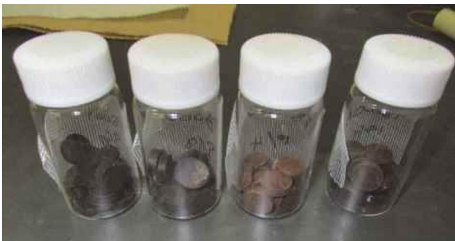
写真 9. ペレット化触媒の配置：縦置き（左）、横重ね（中央）、斜め置き（右）
