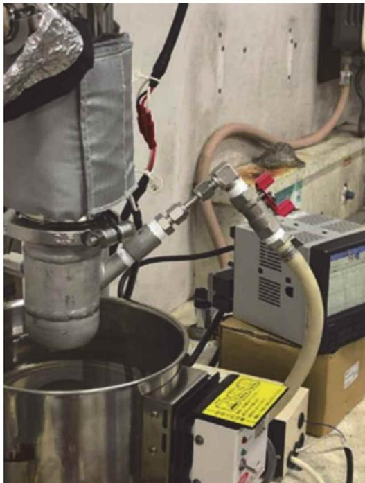
しかしながら、原料液と微粉の触媒の混合液が乳液状となり、プロセス内を循環し経路各所や吸着剤にも乳液が付着した（写真 12）。
