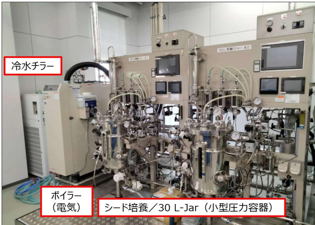
図 2-29 本実証で用いた 30 L-Jar と付帯設備
