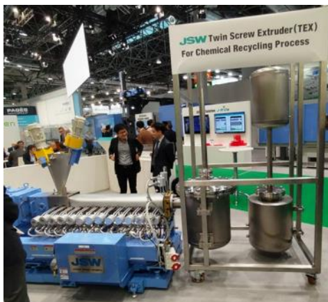
図 5.1.3.2.1.1 PMMA 樹脂のケミカルリサイクル
