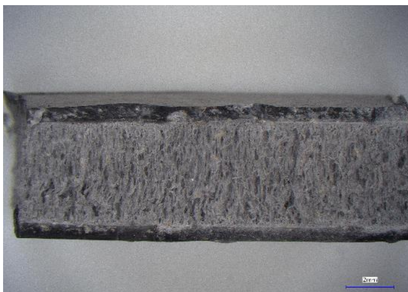
図 1.1 セルロース繊維強化樹脂材料の発泡成形例
