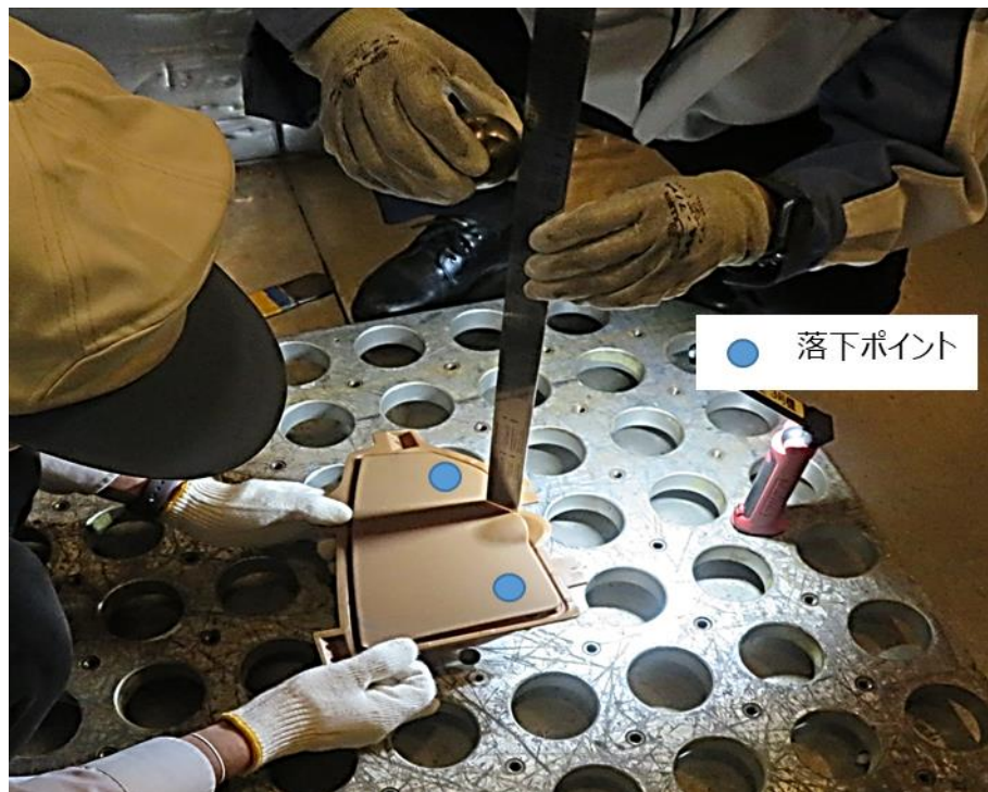
図 3.2.6.1 落錘衝撃試験の様子および落下ポイント
