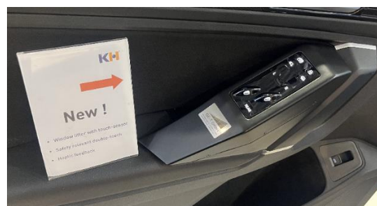
図 5.2.10 タッチ式スイッチ内臓部品
