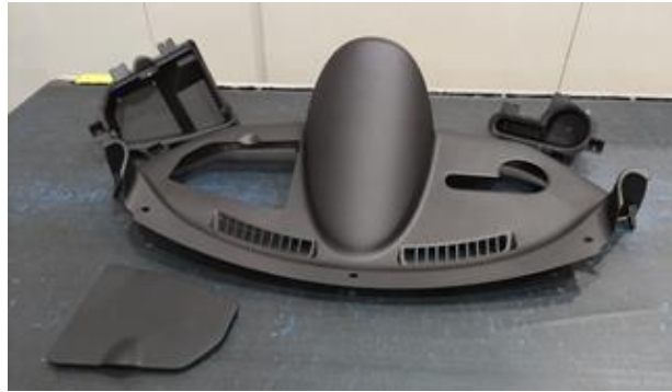
図 3. 2. 4. 1 基本配合②によるコムス・インパネ成形品
