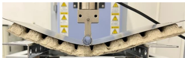
図 2.1.1.1 曲げ剛性測定の様子（旧形状）
