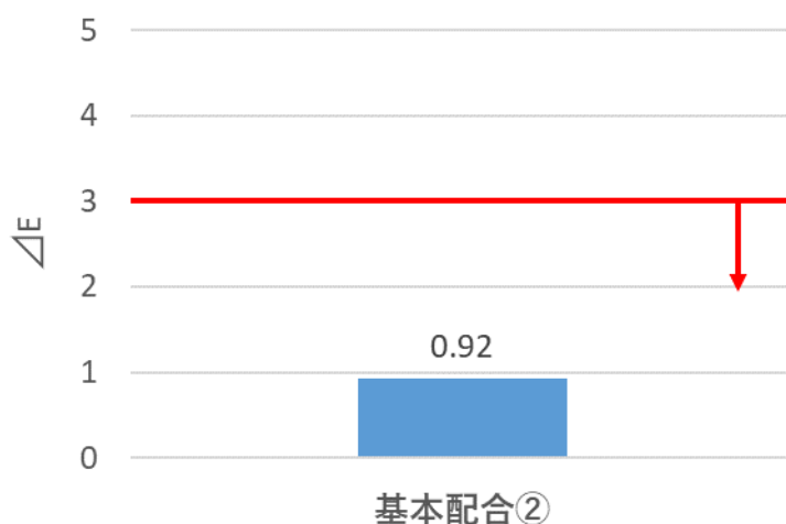
図 3. 2. 8. 1 耐光性試験結果
