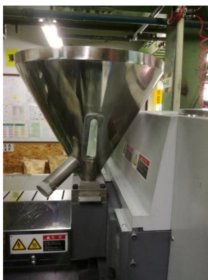
図 1. 3. 1. 4. 2 成形機の方法投入口（ホッパー）
