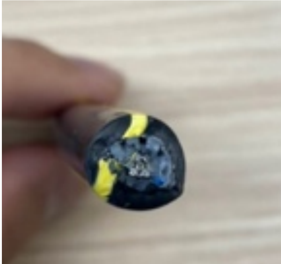
図1-3-1 :光ファイバーケーブル（コア線と硬線が一体型）
