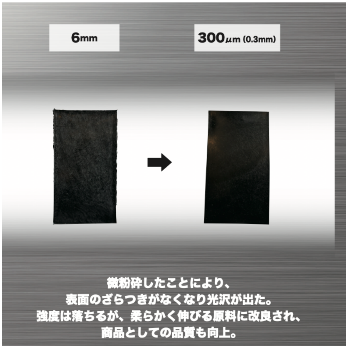
図 2-1-3-3-2 破碎径と混錬による試験片の表面状態の観察
