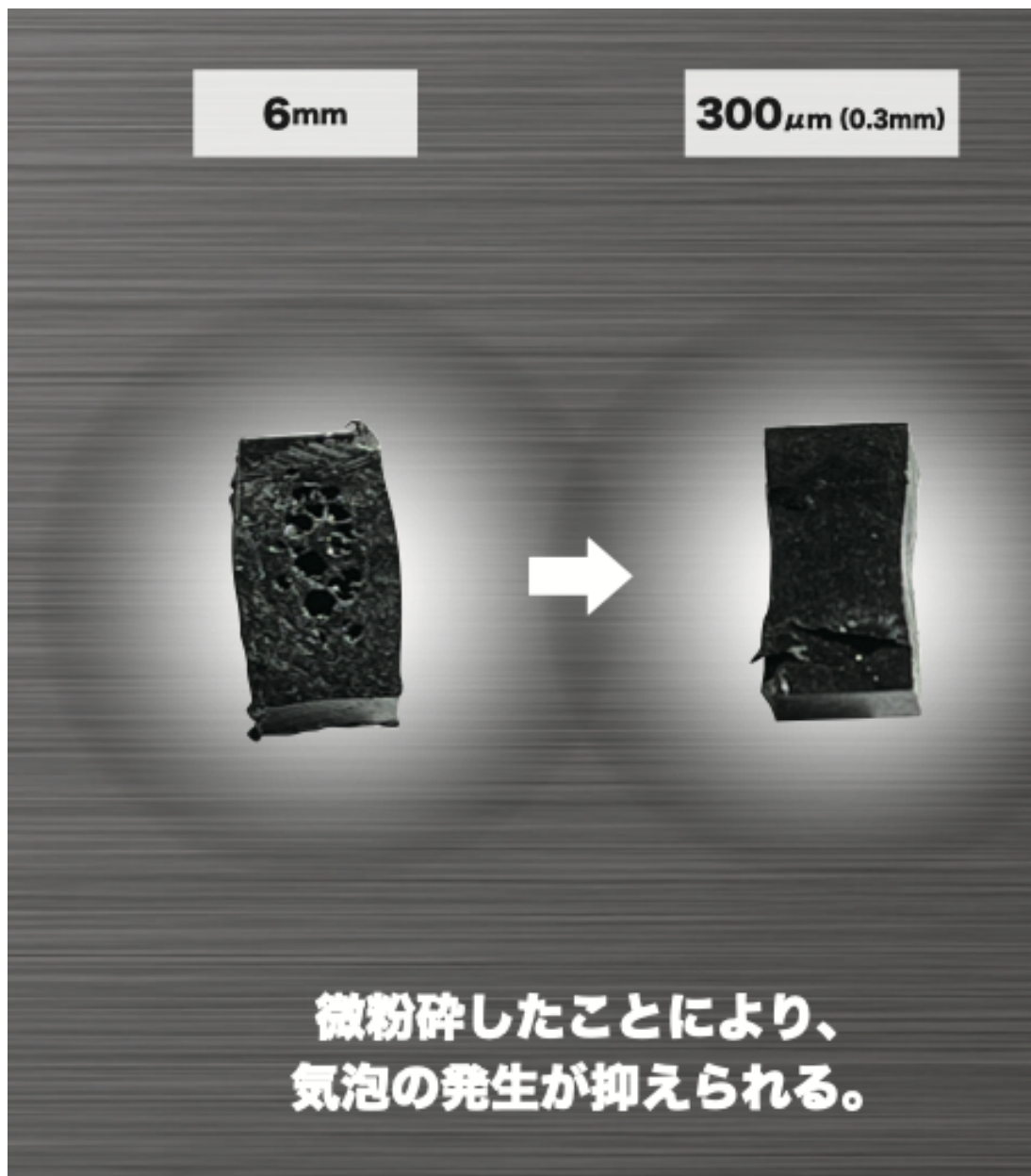
図 2-1-3-3-3 破碎径と混錬による試験片の表面状態の観察及び、内部状態の観察
