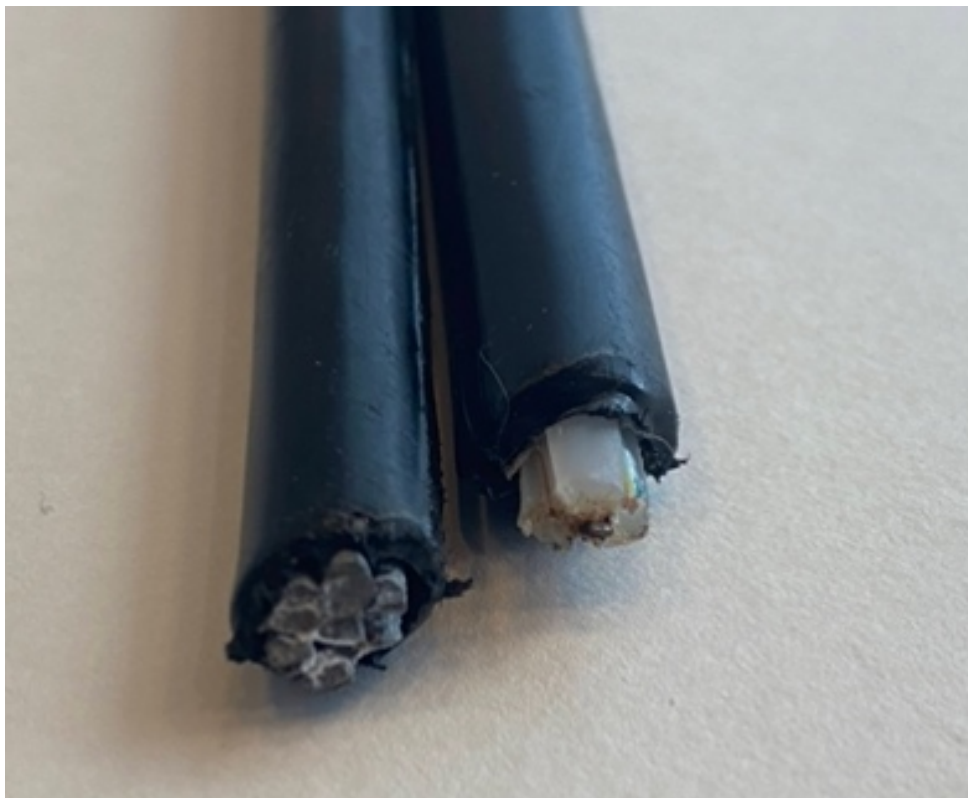
図1-3-2: 光ファイバーケーブル (硬線(左)とコア線(右)が分離する、分離型)
