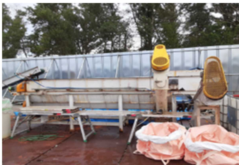
写真 13 比重 1.2 の重液選別装置
