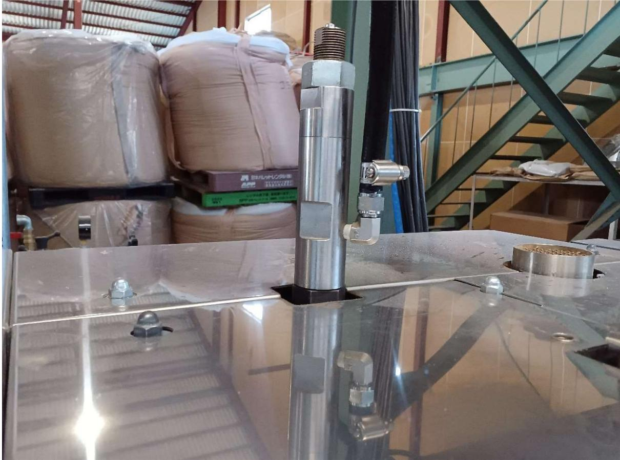
図 2-13 液添加のための加圧弁
