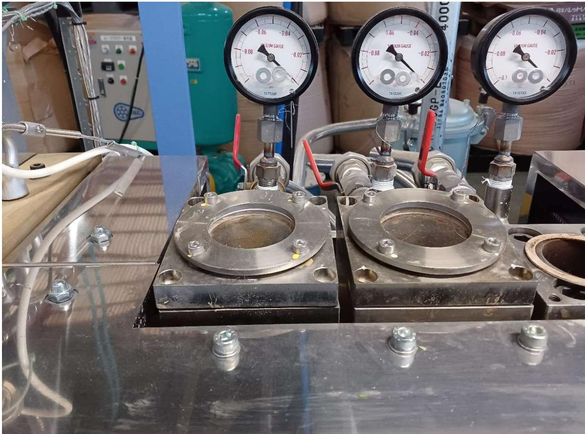
図 2-14 2 か所に増やした真空ポンプによる脱気箇所
