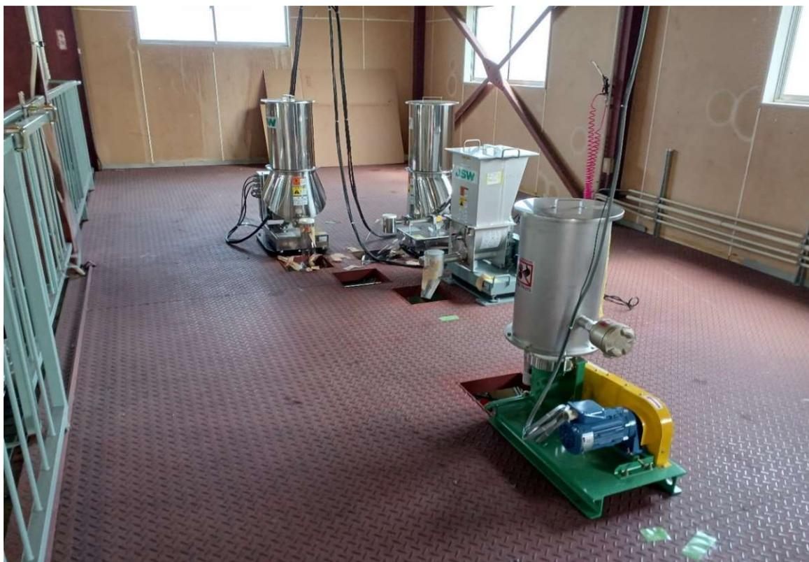
図 2-5 材料供給フィーダー（重量フィーダー）
