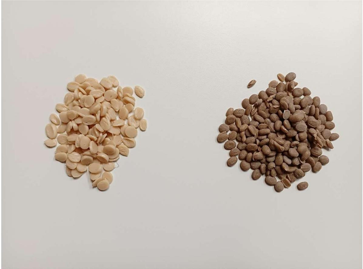
図 2-12 可塑剤を混練したペレット (左) バイオマス粉を混練したペレット (右)
