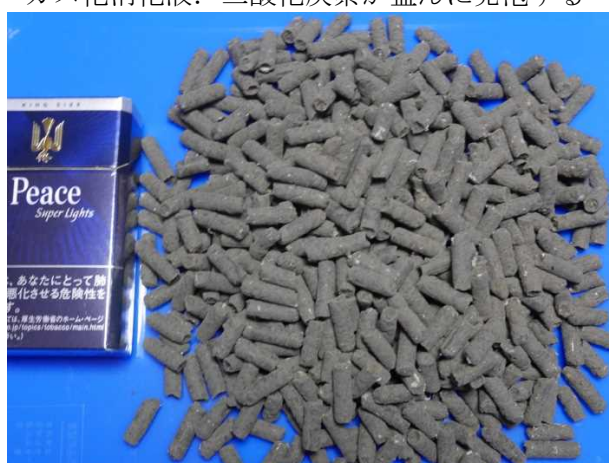
写真 4 乾固したバイオガス化消化液をペレット化したもの。窒素含有率は 2~3% で取り扱いやすくなる。
