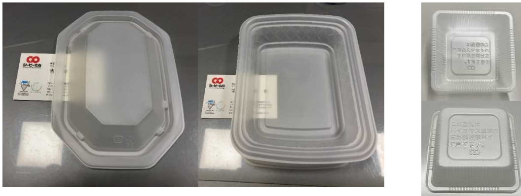
図 13 単発成形機での試作結果（単純な形状の容器）
