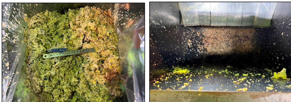
図 49 破碎後試料及び投入口での残存物の状況
