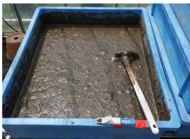
写真 2 硫酸を用いて pH を低下させたバイオガス化消化液。二酸化炭素が盛んに発泡する
