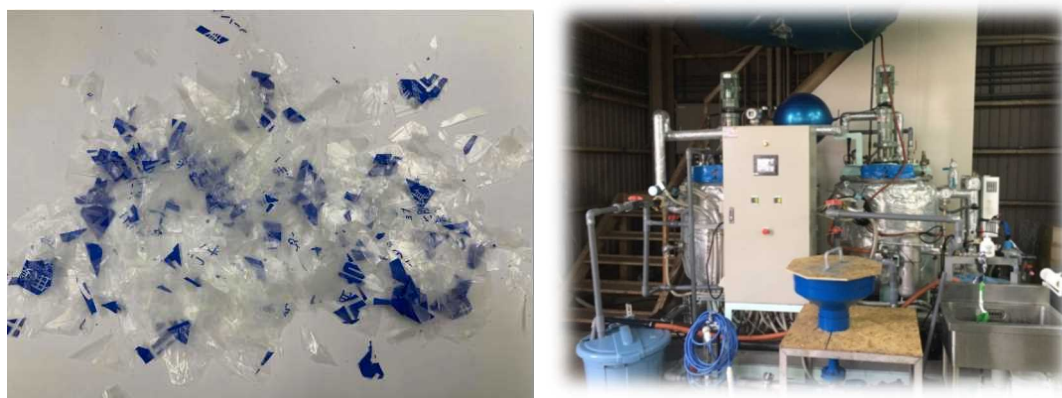
図 50 破碎した PHBH 製生ごみ袋及びメタン発酵試験装置
