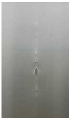
図 66 令和3年度に発生していた薄膜化時の穴開き
