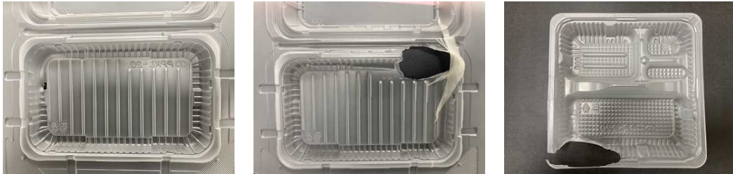
図 14 単発成形機での試作結果（複雑な形状の容器）
