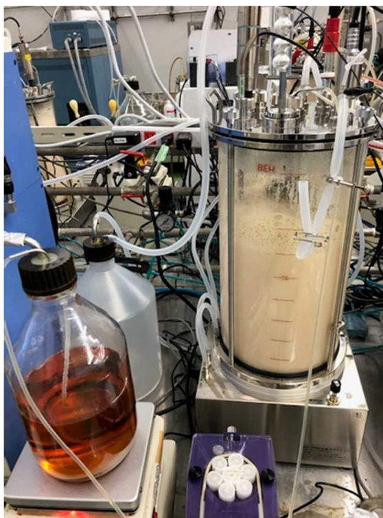
図 37 培養実験装置（10 L ファーマンター）
