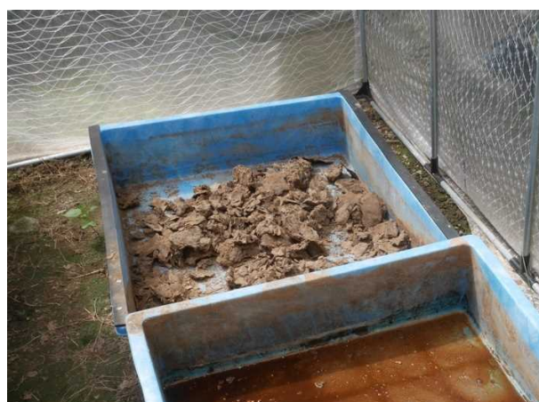
写真 3 乾固したバイオガス化消化液
