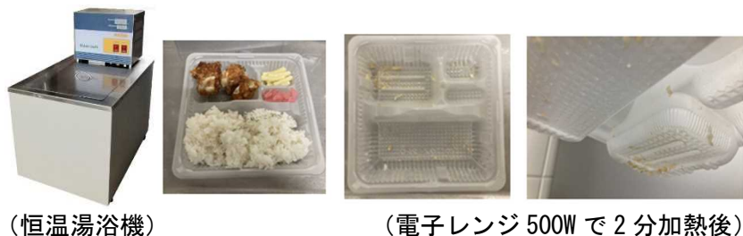
図 22 耐熱温度評価
