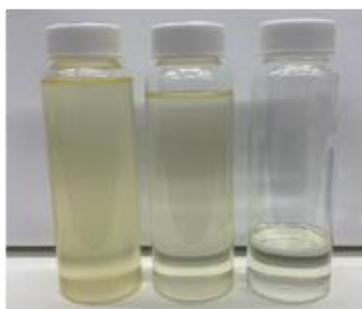
図7-20 重質カット蒸留により得られた C18 以下の留分
