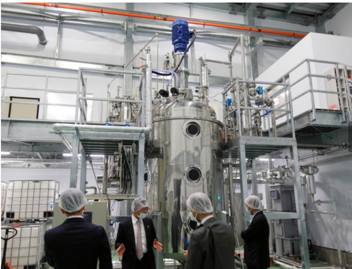
図 6 - 1 本培養試験で用いたユーグリード社の 5kL 培養タンク
