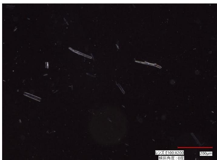
写真 2 糖化处理 5 回後の処理液中のパルプ残渣
