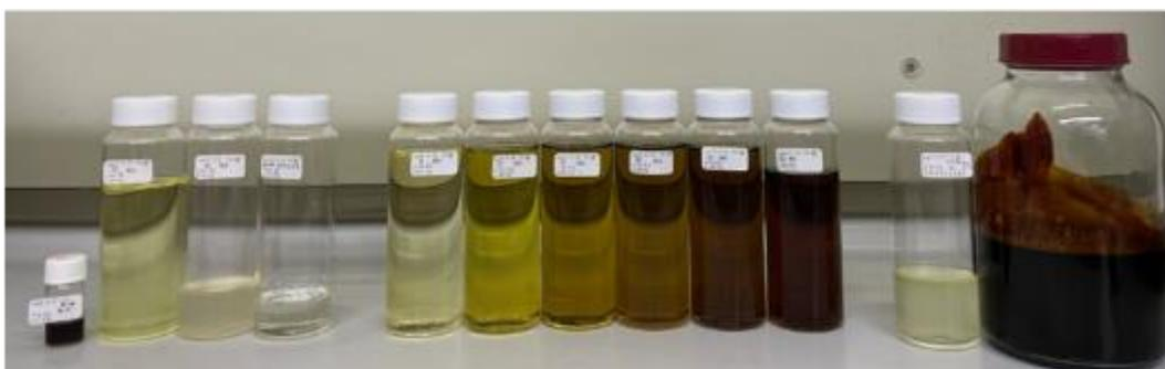
図7-8 重質カット蒸留の結果
