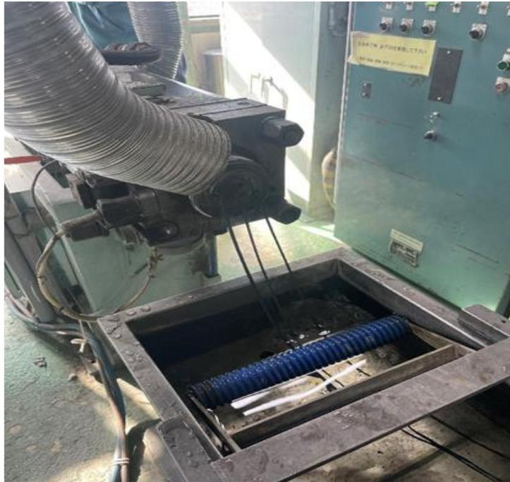
図 10 押出成形機での成形の様子
