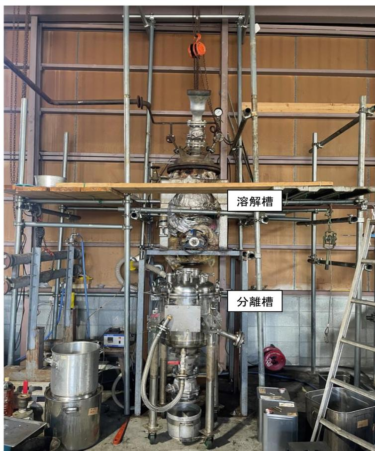
図2 複合材分離装置（バッチ式）
