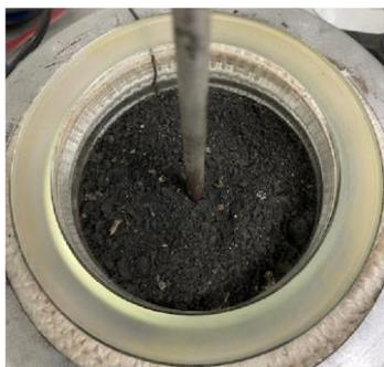
(a) 反応器内 (バッチ: 検体充填)
