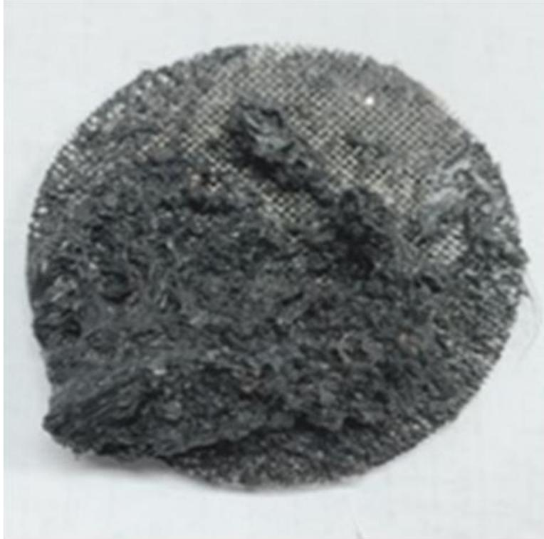
図 14 加工の際に使用したスクリーン 20 に目詰まりした異物
