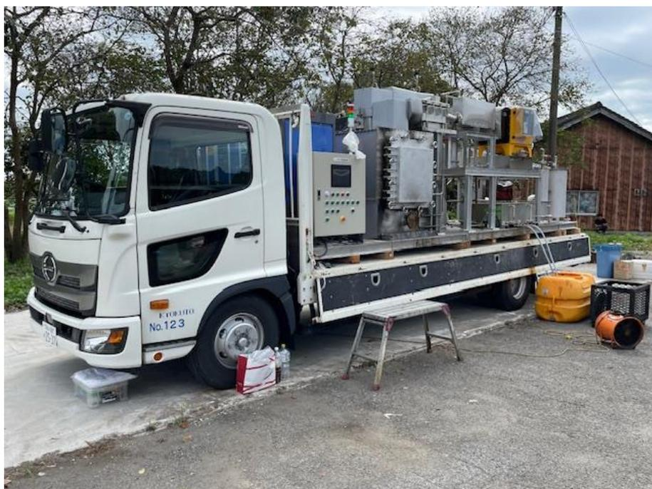
図29 油化試験に使用した開発中の熱分解油化装置
