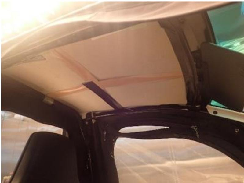
図 3. 1. 2. 2 車両による断熱性試験（パルプモールドの施工状態）
