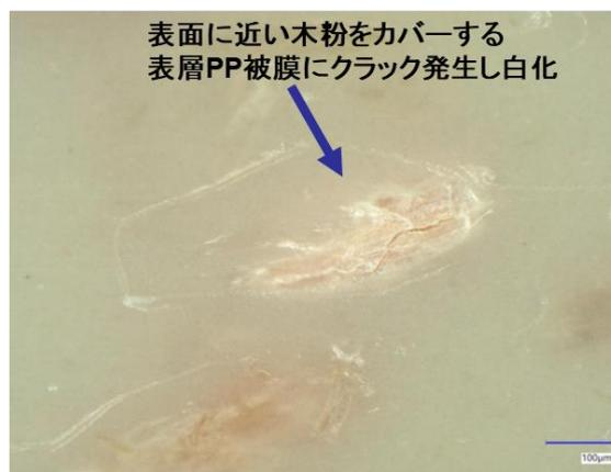
図 1. 3. 2. 2 耐候劣化品表面の拡大観察 2
