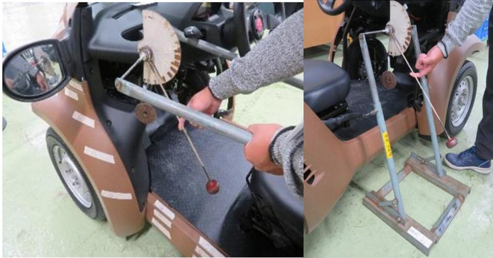
図 1.4.2.1 部品の耐衝撃性試験方法
