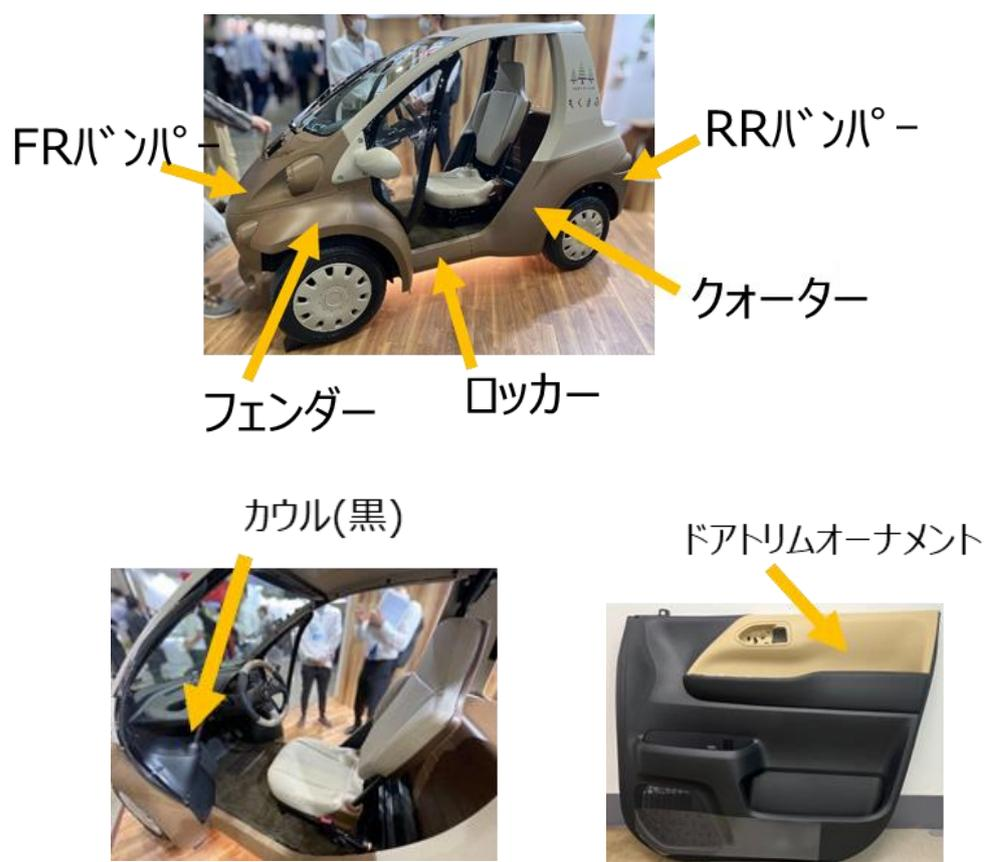
図 1. 2. 1 ターゲット部品（小型 BEV 内外装部品、乗用車ドアトリム）
