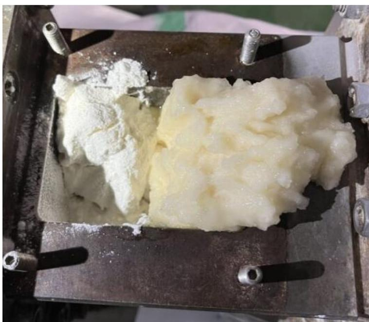
図 27 ホッパー下部 (材料投入口) における材料閉塞による様子 (第1回試作時)
