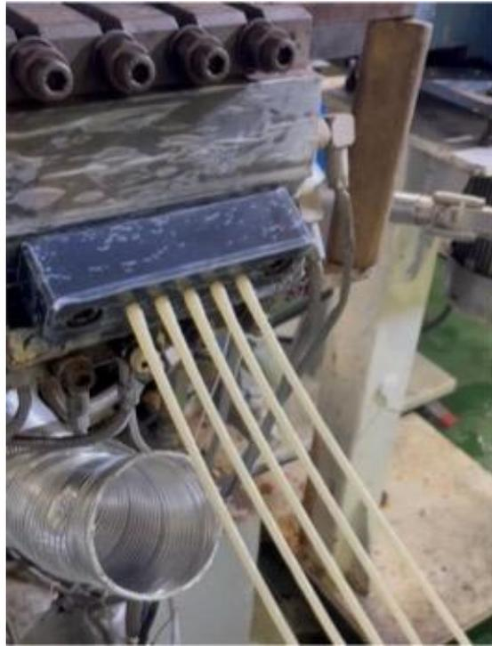
図 30 混練物からのストランド外観（第3回試作時）
