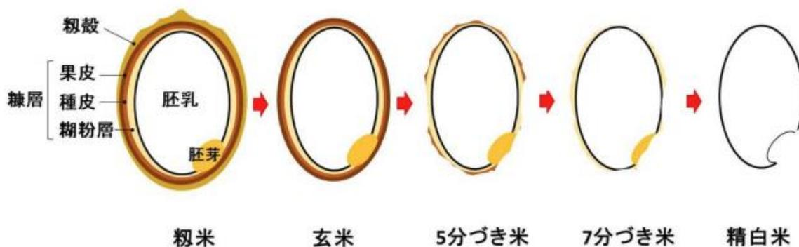
図 16 玄米の構造と精米過程のイメージ図
