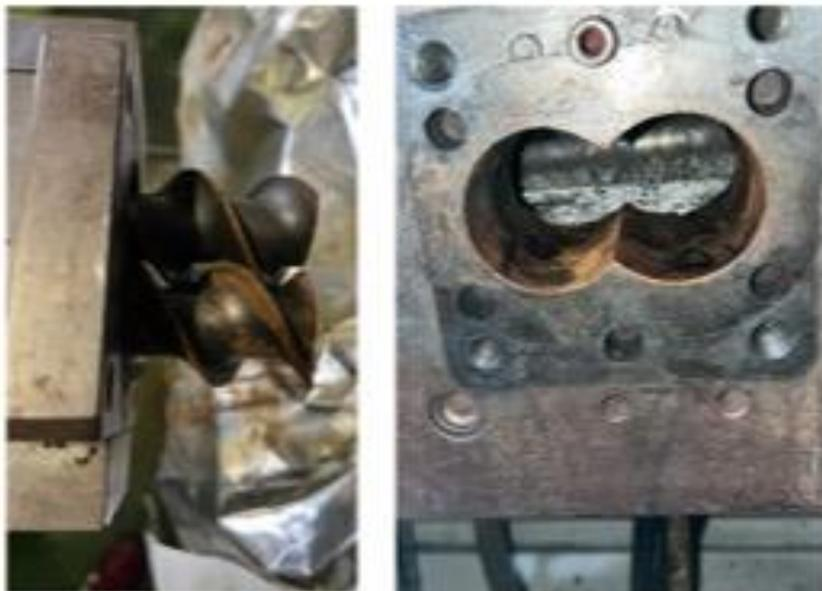
図 33 混練機一部に確認された錆の様子（第 3 回試作時）
