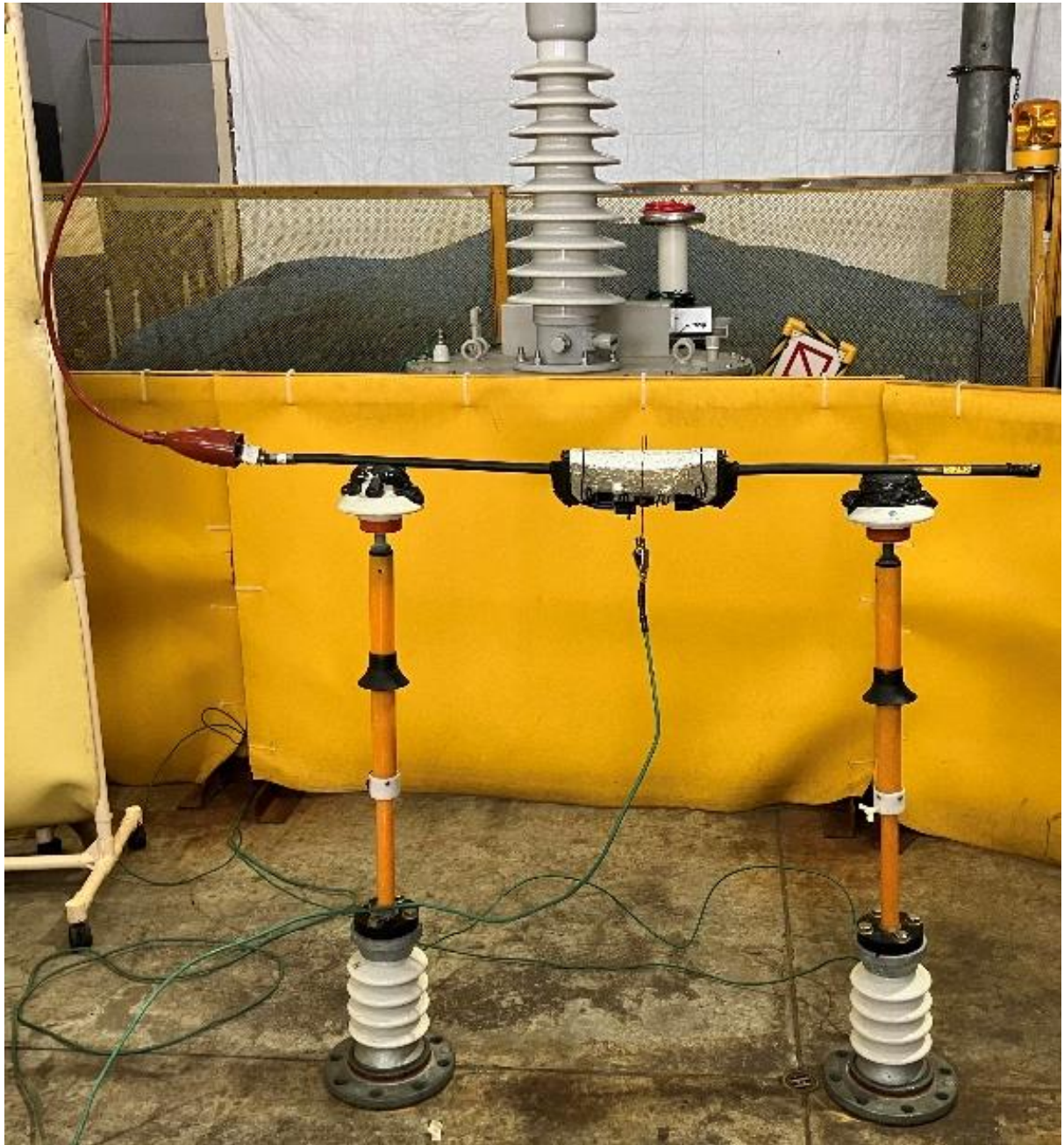
図 4 3 耐電圧試験設備にセット時の写真
