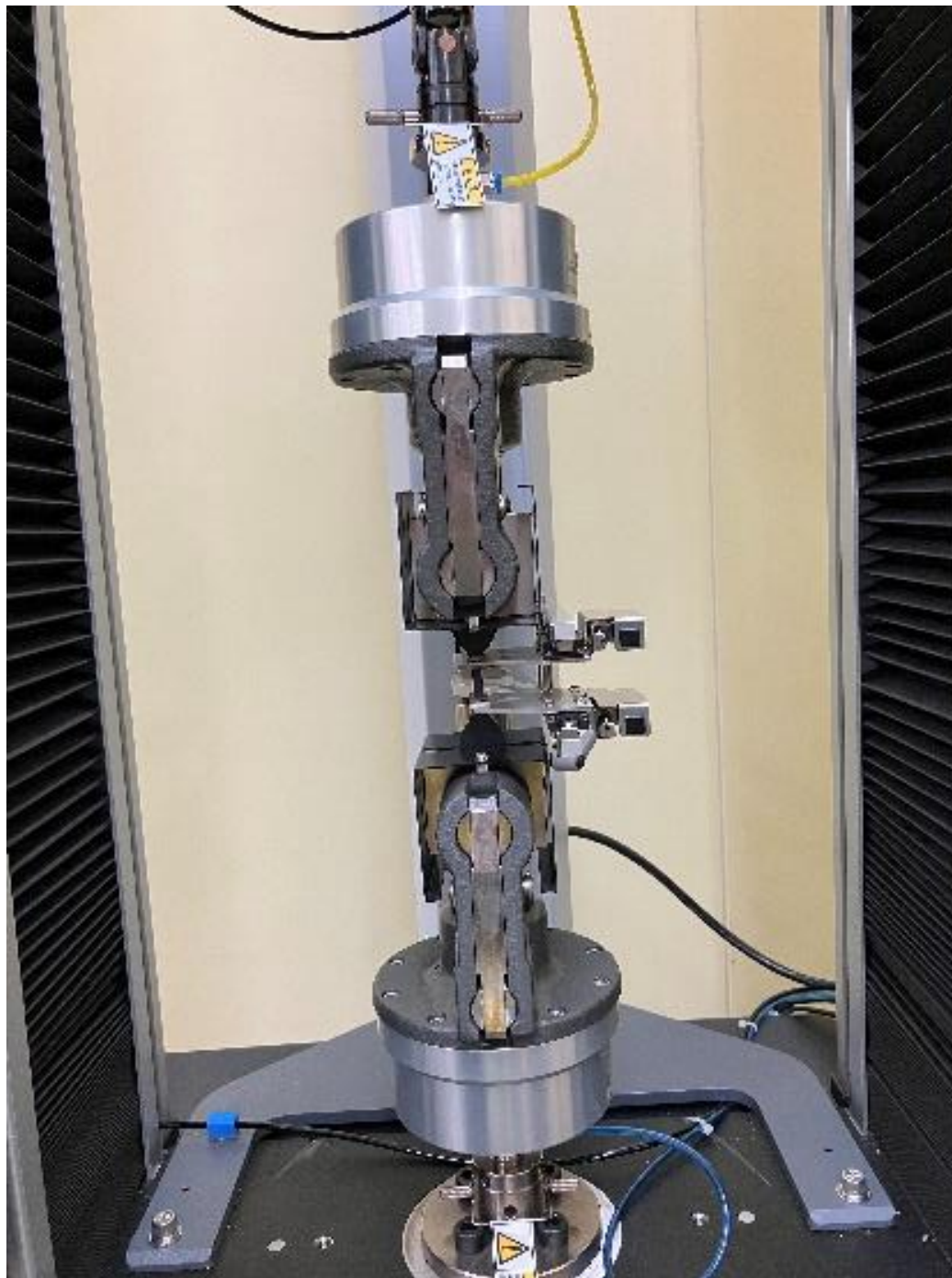
図4 引張試験時の写真
