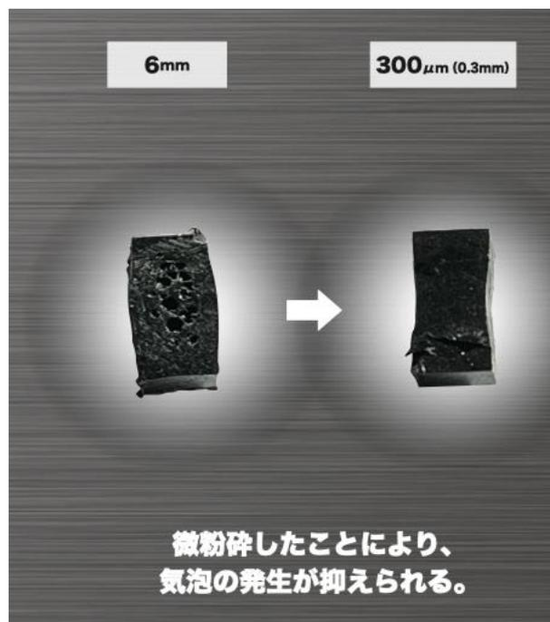
上図より、6mm 破砕のプレートでは、内部に発泡が見られる。一方で、300  $\mu$ m 微粉碎においては、発泡が見られない。
