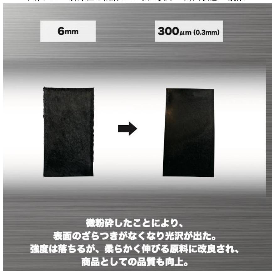
上図より、6mm 破砕のプレートでは、表面に光コア線が析出してしまっており、製品として不適である。また、後述の発泡に起因して表面のざらつきが発生している。発泡による圧力により金型が浮いてしまったことによって、プレート自体に型締め力不足のようなバリが発生している。
