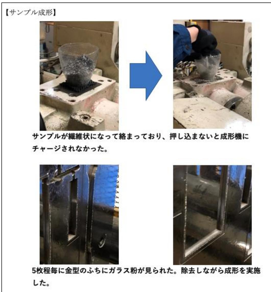
図表 37 破碎時と試験片作成時の状況(後半)
