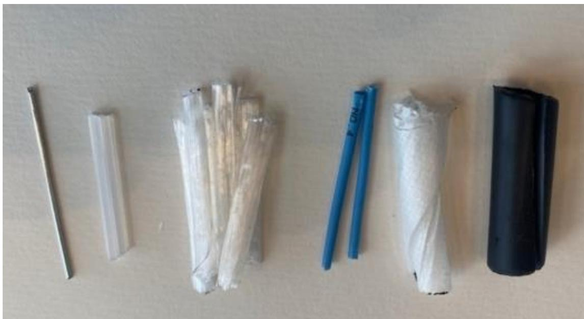
左が内側で右に行くほど外側の素材を並べている。左から鉄芯(鉄)・保護素材(HDPE)・緩衝材(LDPE)・光コア線(ガラス製、PE被覆付)・不織布(PA)・シース(PE)からなる。
