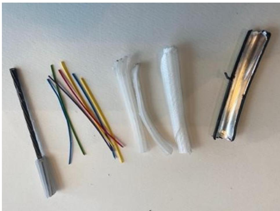
左が内側で右に行くほど外側の素材を並べている。左1番目が硬線（鉄芯に保護素材(LDPE)被覆)。左2番目から順に、ガラスコア、保護素材(HDPE)、不織布、シース(PEにアルミ層が蒸着)からなる。
