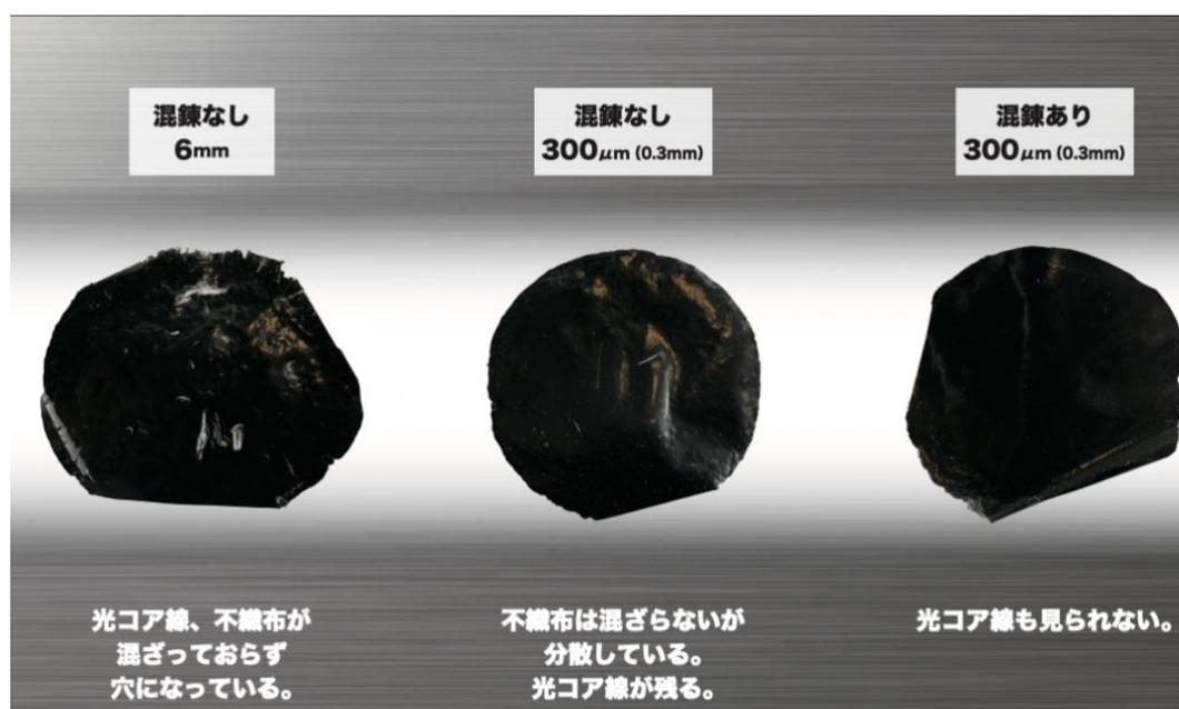
上図より、6mm 破砕で混練をしていない薄片については、破砕されていない 20mm 程度の光コア線が析出し、不織布が、樹脂層と混ざり合っていない。不織布の一部や光コア線の一部は剥離してしまい、穴になっている。
