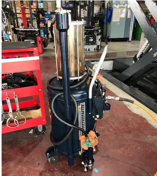
図 4-1-4 抜油機（オイルチェンジャー）
