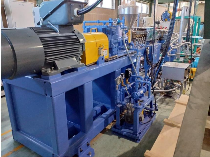
写真 2-3-1 2軸押出機
