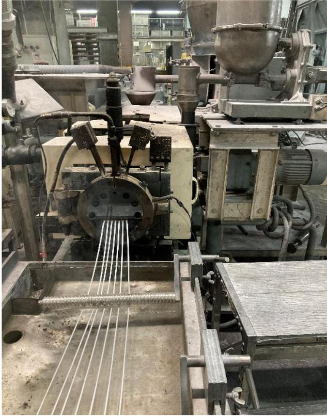
写真 2-12 協力会社の押出機（ストランドカット方式）
