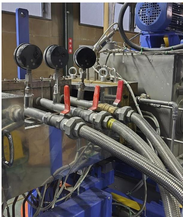
写真 2-5-2 真空ポンプの調整弁
