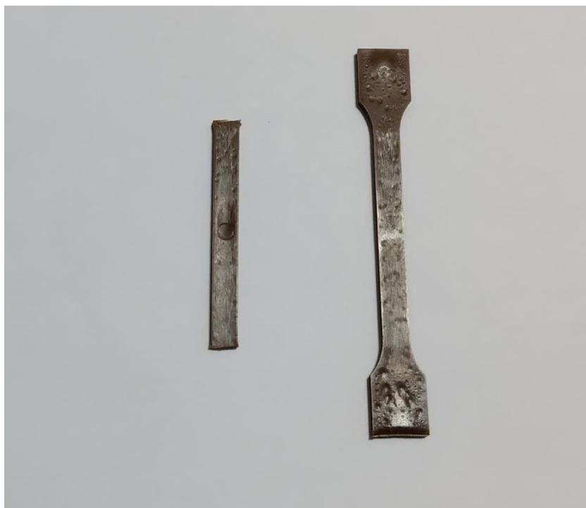
写真 2-18 Mater-Bi①にバイオマス粉を 40%混錬した試験片
