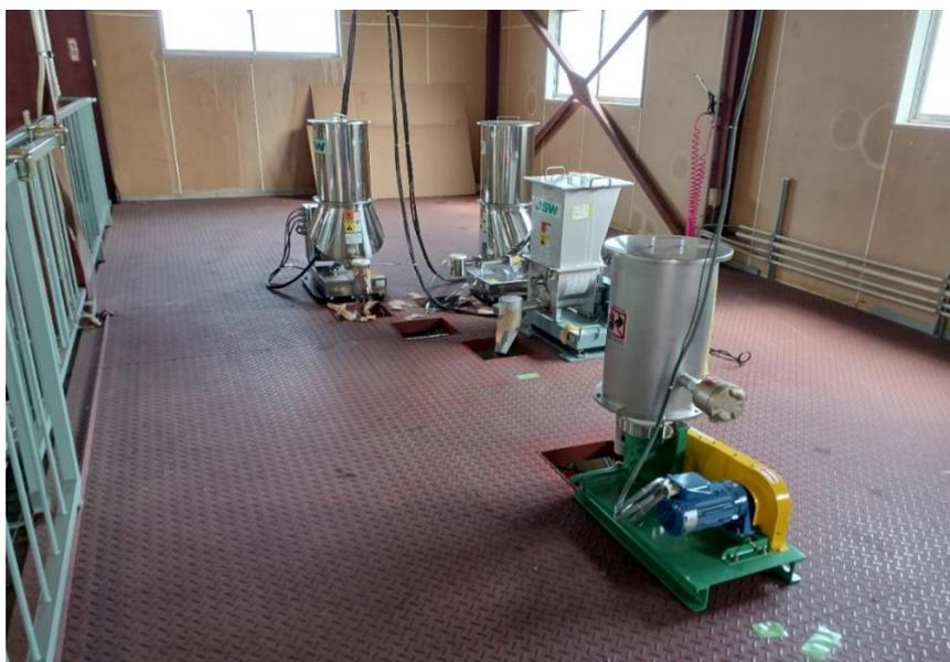
写真 2-6 材料供給フィーダー（重量フィーダー）
