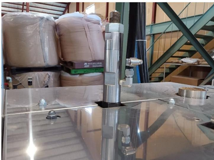
写真 2-10 液添加用の加圧弁
