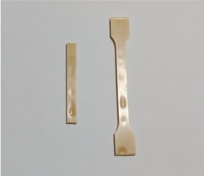
写真 2-16 Mater-Bi①に可塑剤を 20 重量部混練した試験片
