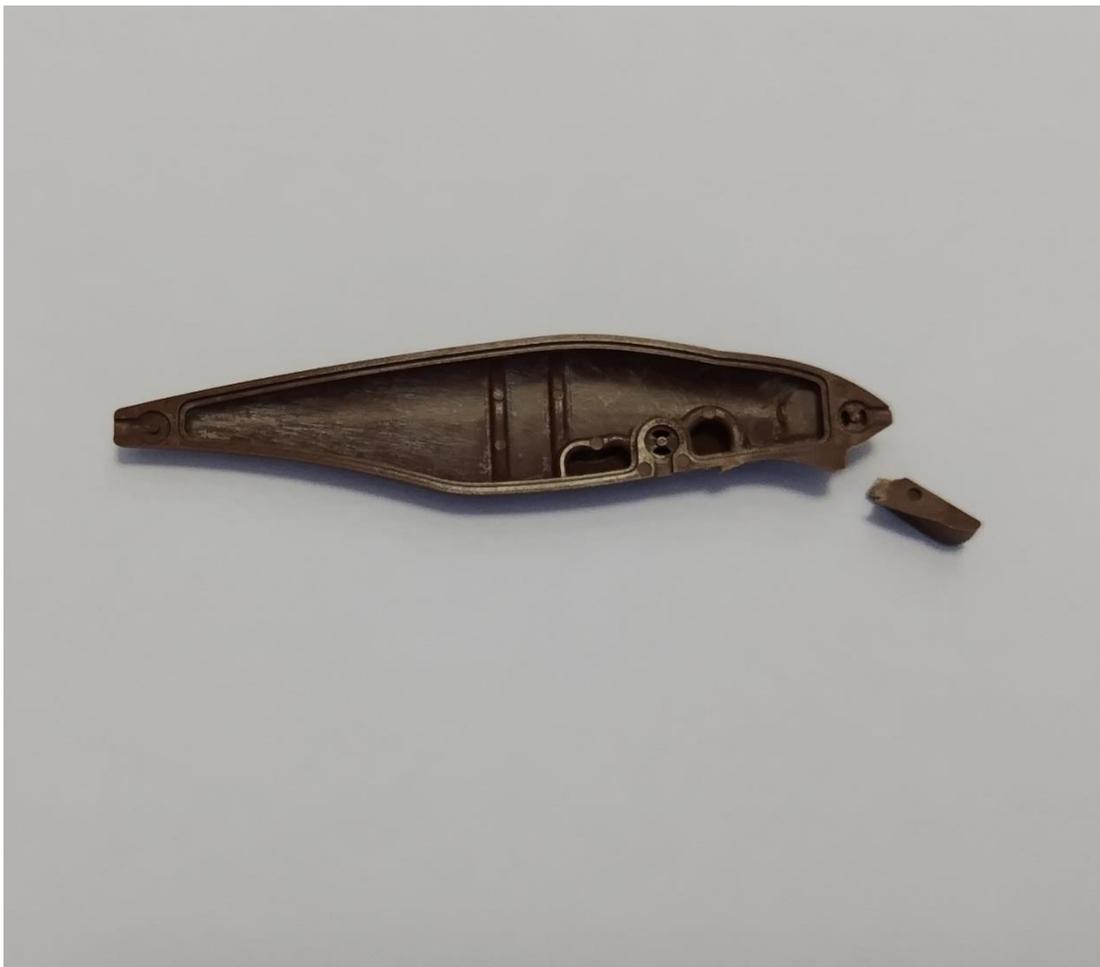
写真 2-19 一部が折れたバイオマス粉 40%配合の射出成型品
