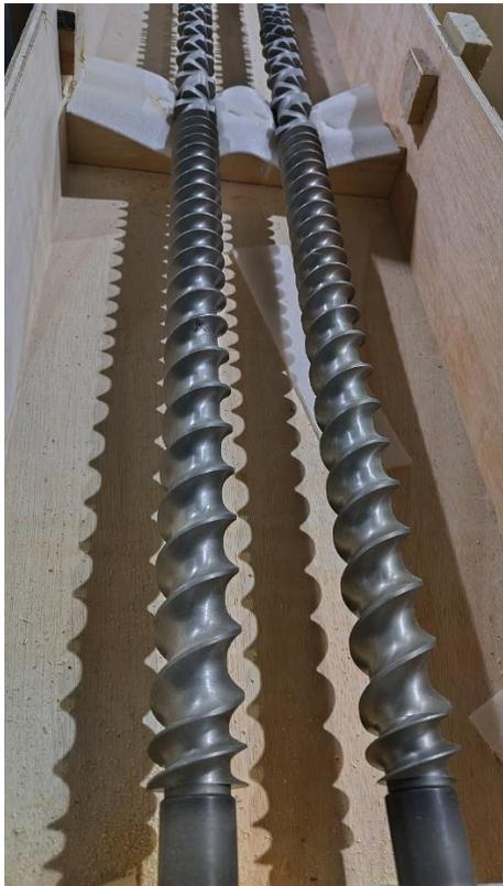
写真 2-3-2 2軸押出機のスクリー
