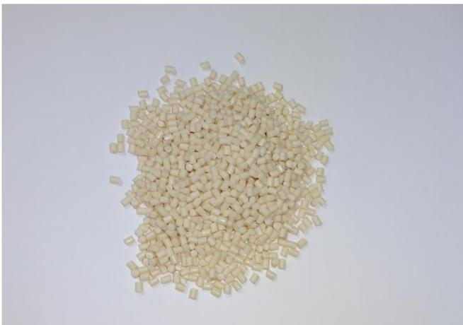
写真 2-13 ストランドカットで製造した 20 重量部を液添加したペレット
