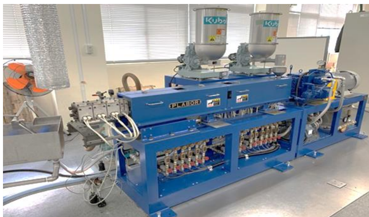
図 3.4-1 福岡大学で設計・試作した熔融樹脂溜まり部付きの押出機
