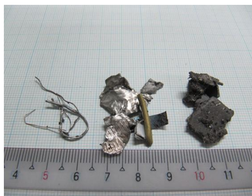
図 3.3-15 製品プラ中の磁着物（一部）
