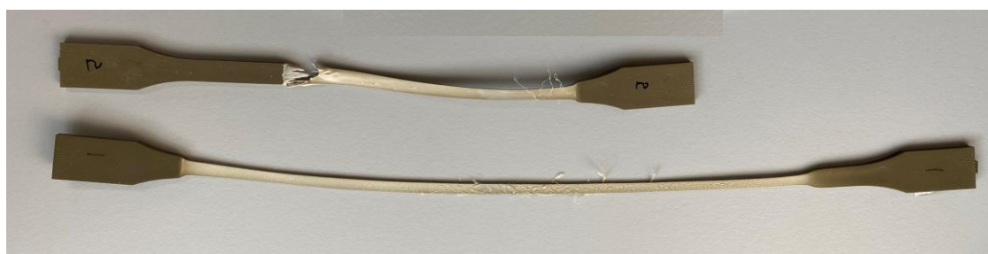
図 3.4-2 PP が主成分の容器包装リサイクルプラスチックにおける各試験片の引張試験後の状態
