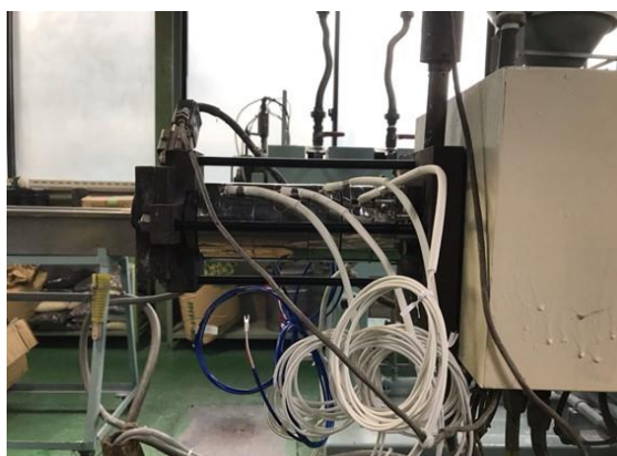
図 3.3-12 試験用 2 軸押出機への樹脂溜まり設置状態
