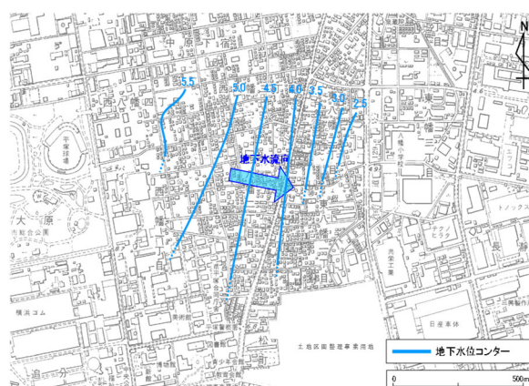
図2-4 地下水の流れと地下水位等高線 秋季：令和6年11月測定 (地下水位等高線の単位：標高 T.P. + m)
