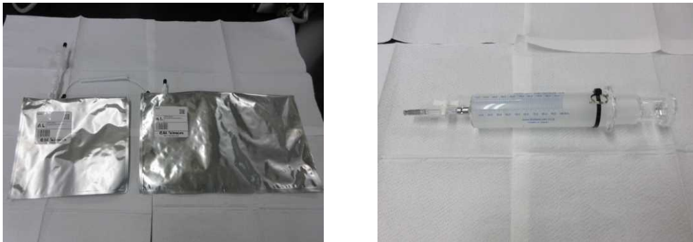
図 5.2-2 気泡採集容器例（左；アルミバッグ、右；ガラスシリンジ）
