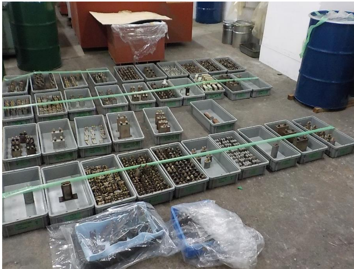
ひとつひとつ手作業で取り外した小型コンデンサ900台
