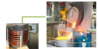
【誘導加熱式】※電気を使用
