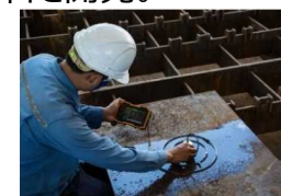
左図：液体接触媒質を使用した従来の超音波検査（上記①） 右図：風力発電における昆虫の衝突・付着の状況（上記②）
