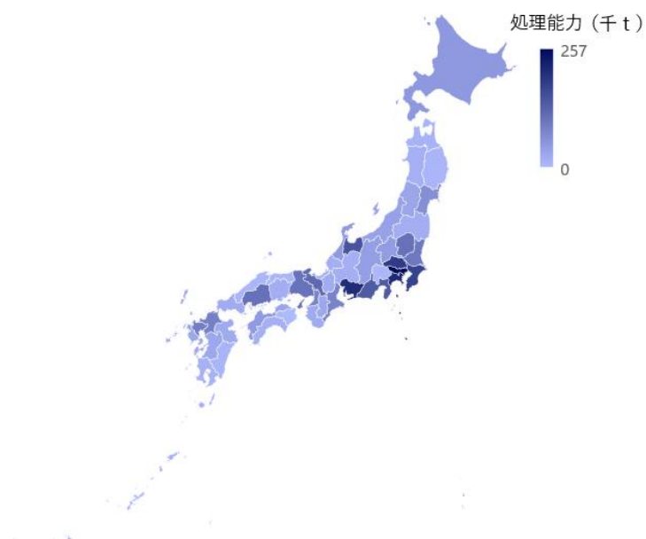
図5 優良認定業者による建設系廃プラスチックの処理能力状況
