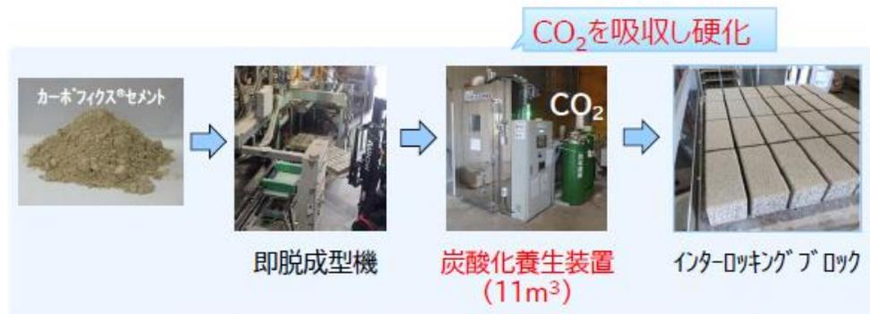
従来製品に比較して大幅にCO<sub>2</sub>を削減したILブロックを実工場で製造
