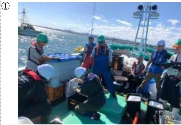
韓国の専門家が400Lタンクから20Lプラスチックコンテナ容器に海水試料を分取している様子。
