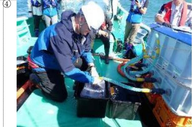
スイスの専門家が400Lタンクから20Lプラスチックコンテナ容器に海水試料を分取している様子。
