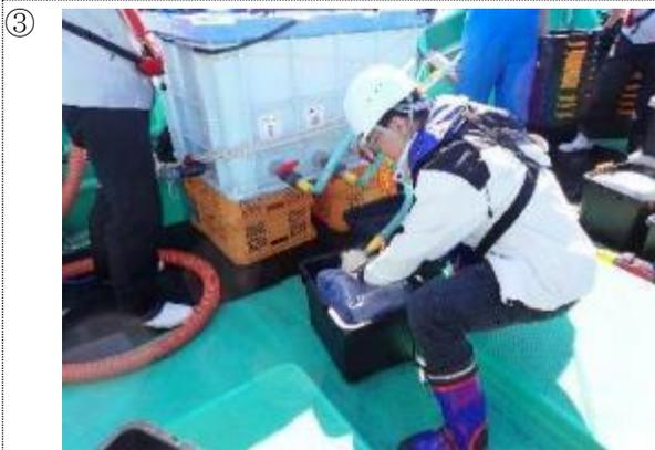
中国の専門家が400Lタンクから20Lプラスチックコンテナ容器に海水試料を分取している様子。
