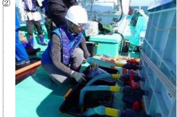
IAEAの専門家が400Lタンクから20Lプラスチックコンテナ容器に海水試料を分取している様子。
