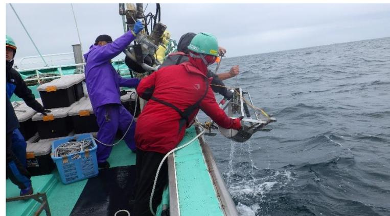
採取船上での海底土試料の採取
