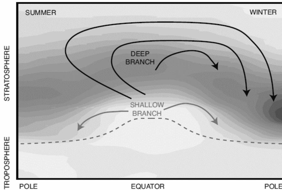
図1-資-5 ブリュワー・ドブソン循環のふたつの経路、浅い経路（shallow branch）と深い経路（deep branch）の模式図。
