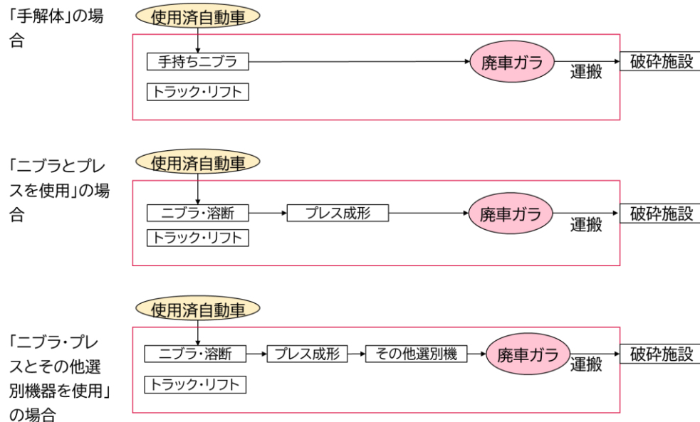
図 2-1 解体工程の処理パターン別フロー図
