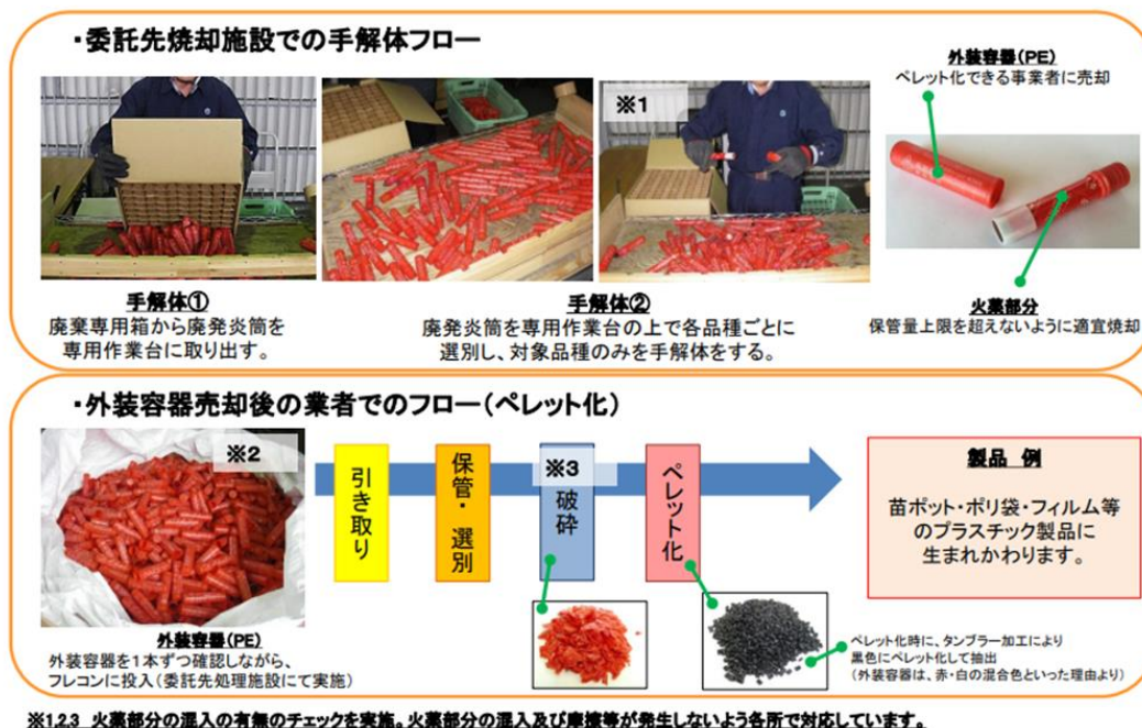
図 1-24 廃発炎筒の手解体フロー及び外装容器(PE)の再資源化フロー
