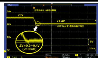
最適なインダクタンス決定後の耐サージ試験・過渡応答
