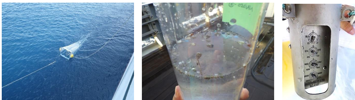
写真Ⅲ-1 ニューストーンネットの曳網風景と、ポリエチレン容器に採取した試料、濾水計
