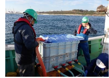
61核種分析用海水の採取 （大型容器への採水）
