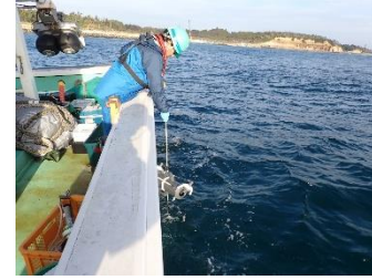
トリチウム分析用海水の採取 （ニスキン採水器の投下）
