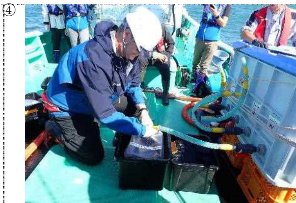
④ スイスの専門家が400Lタンクから20Lプラスチックコンテナ容器に海水試料を分取している様子。
