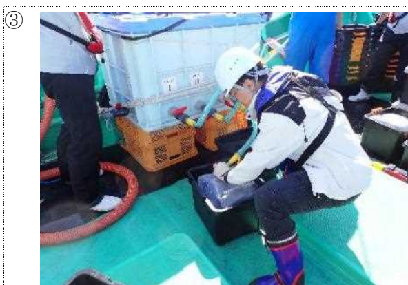
③ 中国の専門家が400Lタンクから20Lプラスチックコンテナ容器に海水試料を分取している様子。
