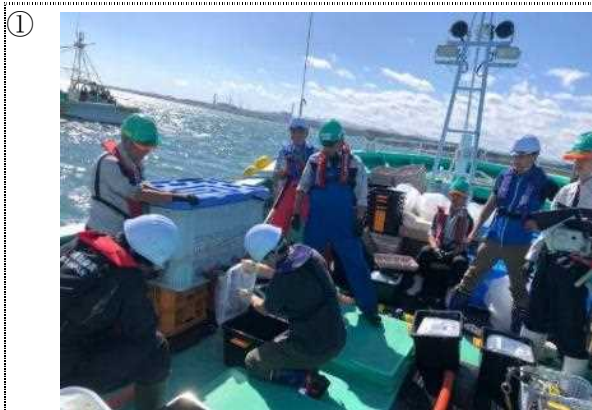
① 韓国の専門家が400Lタンクから20Lプラスチックコンテナ容器に海水試料を分取している様子。(写真はIAEAの公開ホームページより引用)
