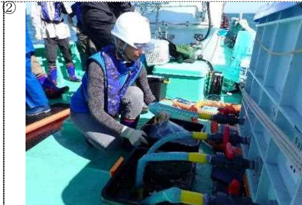
② IAEAの専門家が400Lタンクから20Lプラスチックコンテナ容器に海水試料を分取している様子。
