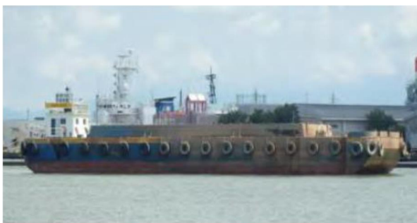
↑ 土運船を用いた浚渫土砂の運搬
