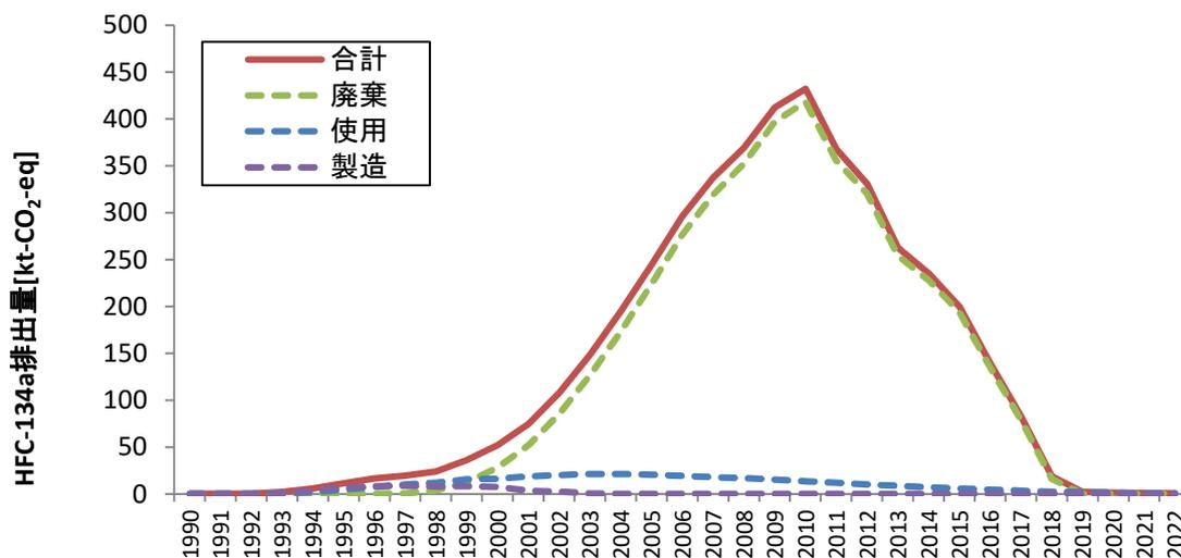
図 1 「2.F.1.- 家庭用冷蔵庫の製造、使用及び廃棄」からの HFC-134a 排出量の推移
