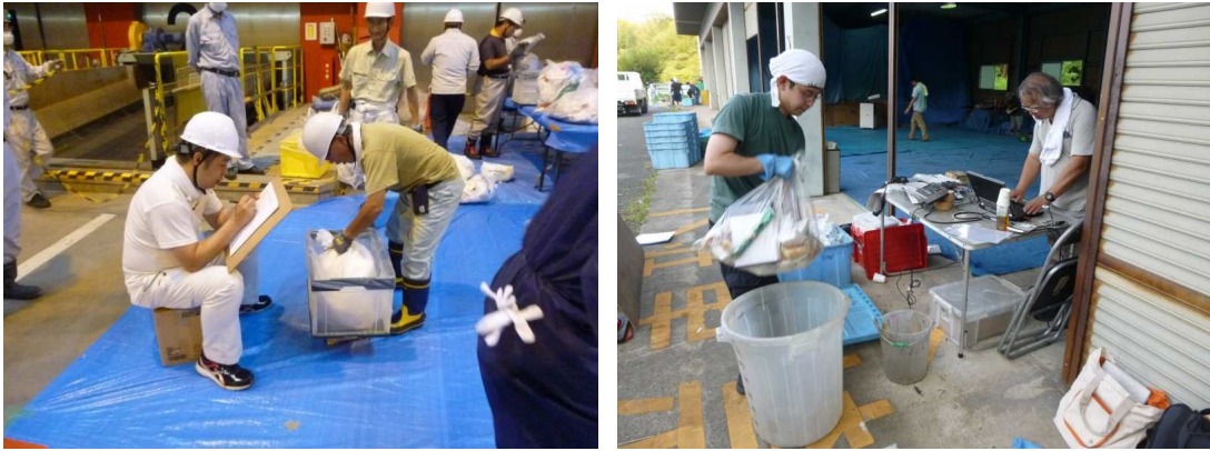
図表 8 調査対象試料の重量・容積の計量の様子
