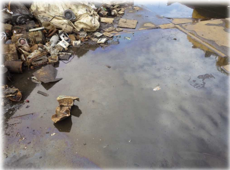
【写真】屋外保管に伴う油汚染
