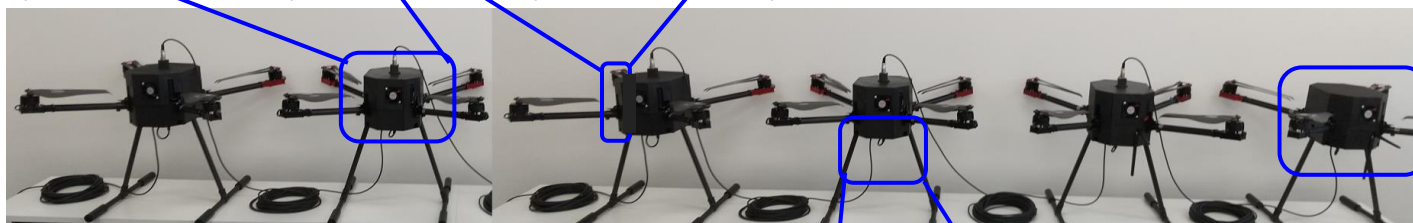
2024年4月 各20m 有線給電ケーブル x6 機
