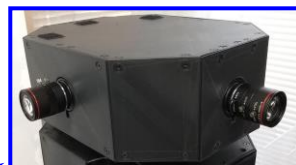
搭載例2 全方位録画用カメラ [超高解像度16K]
