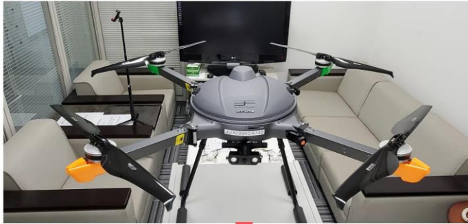
実験時 1m 級産業用ドローン (12S・5kg 積載)
