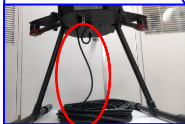
ドローンタワー / 連結有線給電ドローン特許 請求項7の給電ケーブル脱着可能な状況
